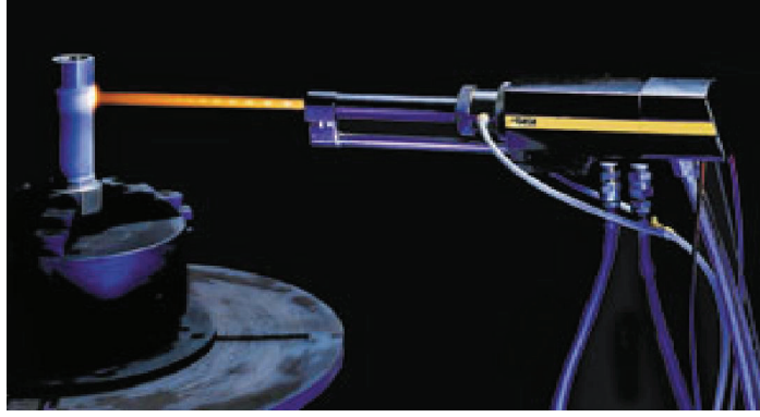
Şekil 2.27 : Modern bir HVOF termal spreyleme [48].
