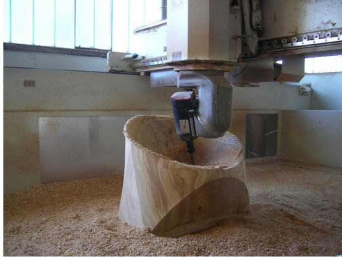
Şekil 3.26. Kairo sandalyenin cnc tezgahta işlenme süreci [66].
