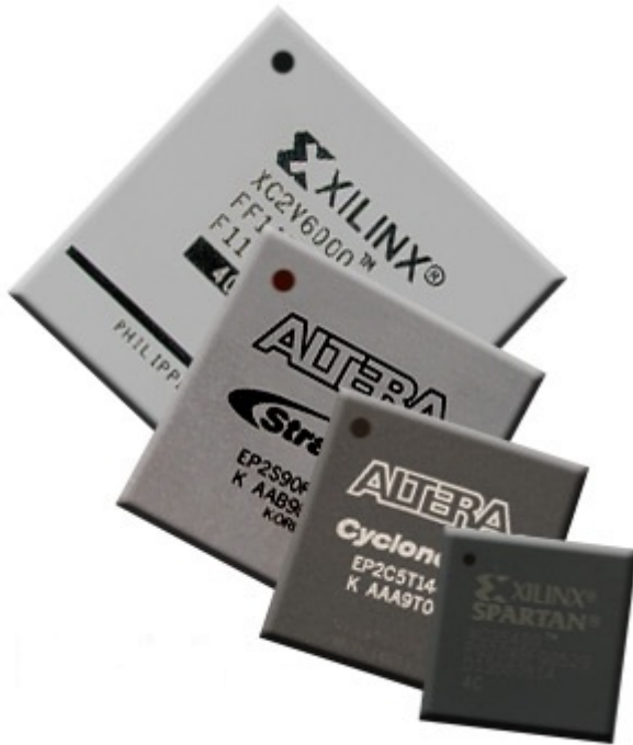
Resim 2.1. Altera ve Xilinx firmaları tarafından üretilen bazı FPGA'ler
