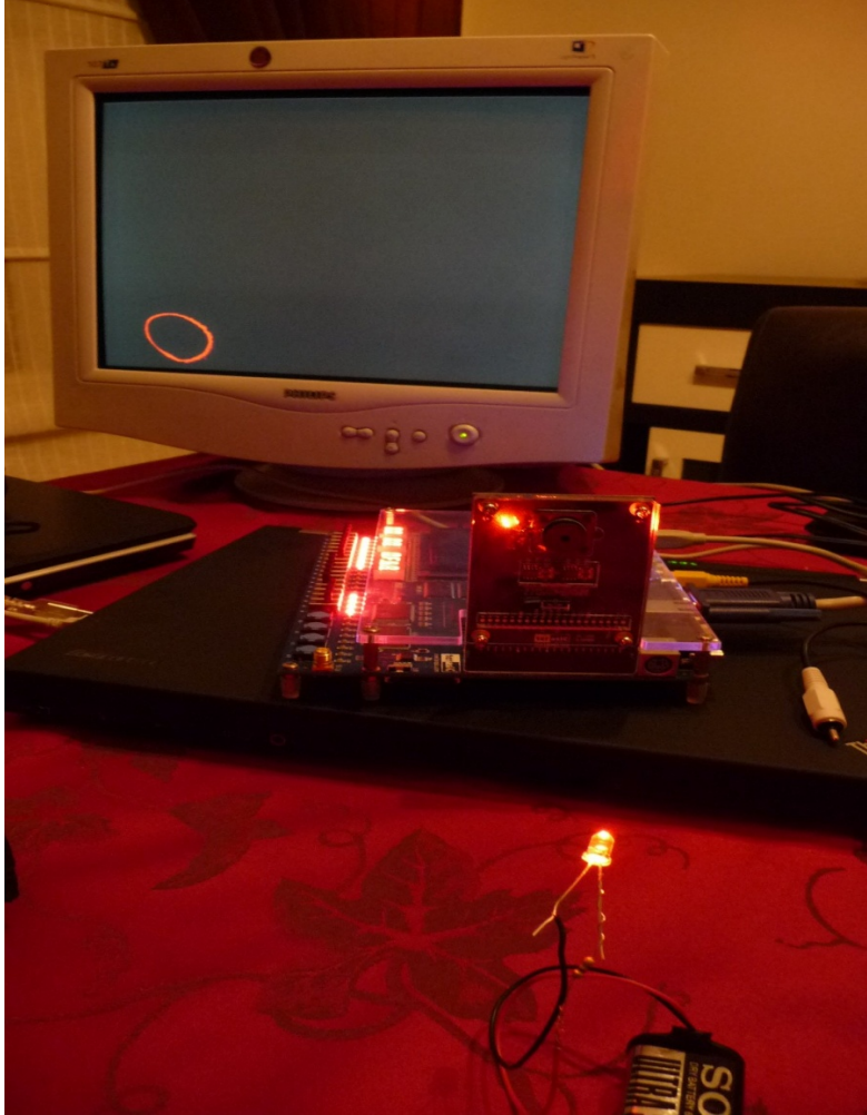
Resim 5.2. Geliştirme kartının kamerası önünde çalışan kırmızı bir LED ve kırmızı ışık konum bilgisinin monitördeki görüntüsü
