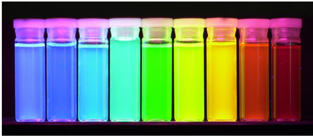
Şekil 2.1 CdSe/ZnS kuantum dot çözeltilerinin UV ışığı altında lüminesans emisyonları. Kuantum dotların boyutu yaklaşık 2nm 'den, 6nm 'ye kadar artmaktadır (sağdan sola) [Tomczak ve ark. 2009].
