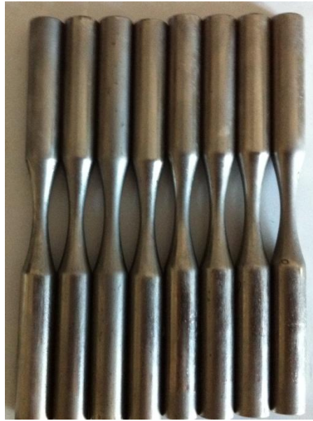
Şekil 6.2 : BONDAL DIP İşlemi Sonrası Alüminyum Yorulma Numuneleri.
