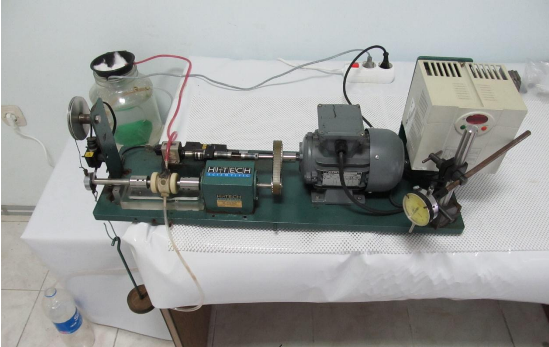
Şekil 6.10: Korozyonlu Yorulma Deneylei için Deney Düzeneyi
