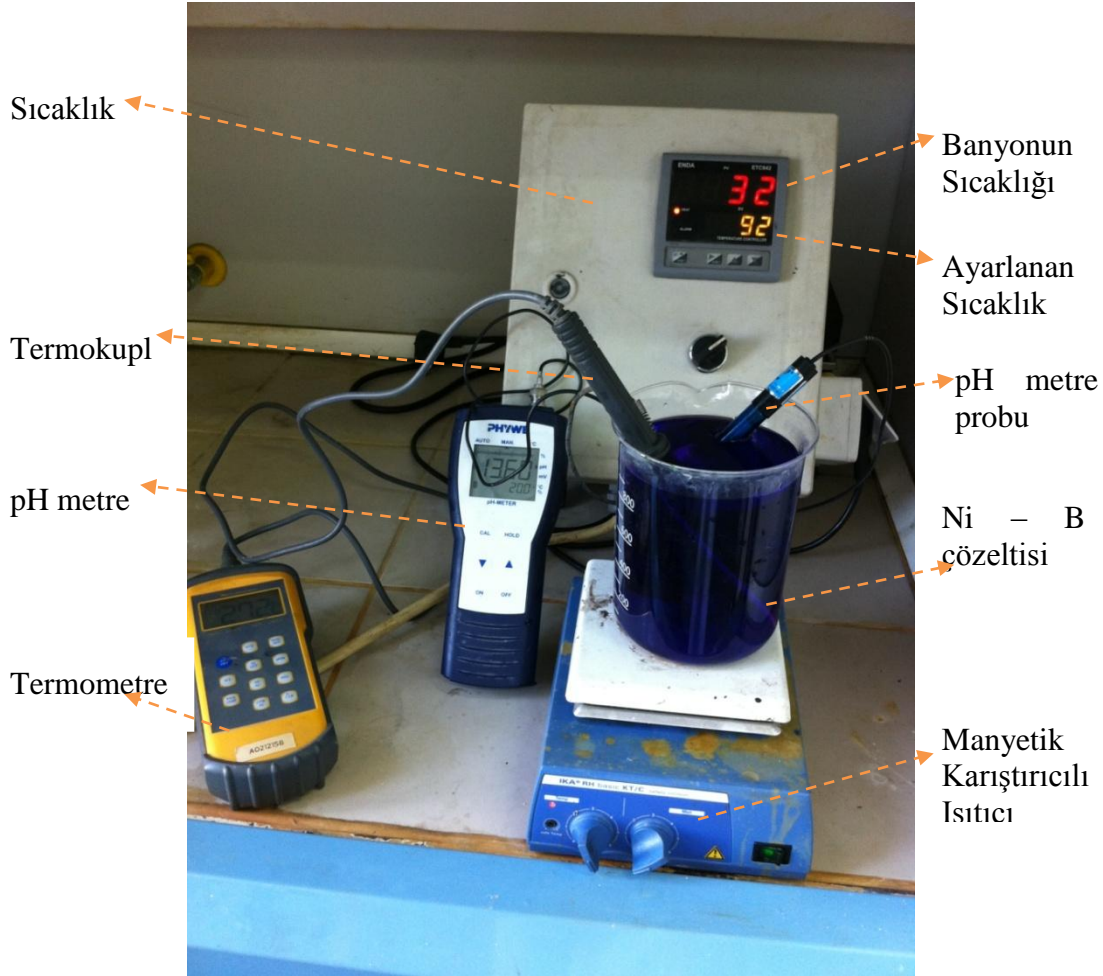
Şekil 6.3 : Akımsız Nikel Kaplama Yapılan Deney Düzenegi.
