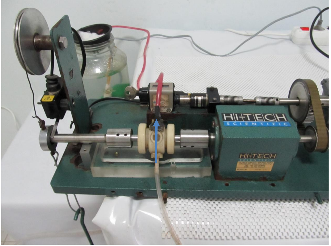
Şekil 6.11: Korozyonlu Yorulma Deneyleri için Deney Düzeneği
