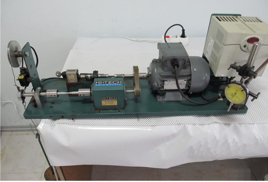
Şekil 6.9: Havada Gerçekleştirilen Yorulma Deneylei için Deney Düzeneyi
