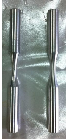
Şekil 6.1 : BONDAL DIP İşlemi Öncesi Alüminyum Yorulma Numuneleri.
