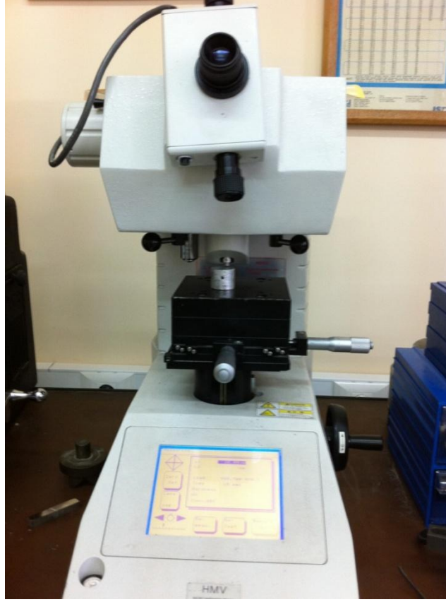
Şekil 6.6 : MicroVickers Sertlik Ölçümlerinde Kullanılan Sertlik Cihazı
