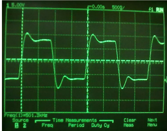
Şekil 6.9 Tel sarımlı gate direnci ile sürülen MOSFET için gate-source gerilimi dalga şekli
