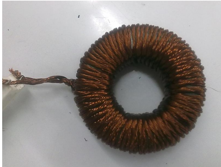
Şekil 6.19 Yüksek frekans akım transformatörü
