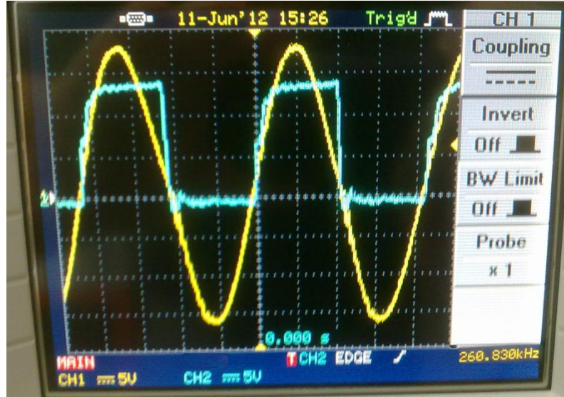
Şekil 6.20 Paralel rezonans gerilimi (CH1 –Sarı - 5V/div) ve MOSFET gate-source gerilimi (CH2 – Mavi - (5V/div)
