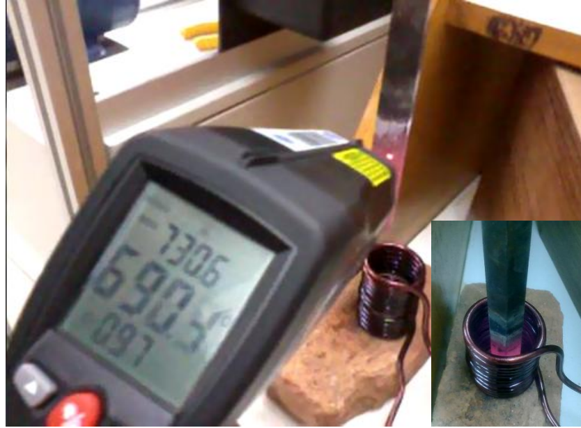
Şekil 6.22 Krom-Nikel parçanın indüksiyon ile ısıtılması
