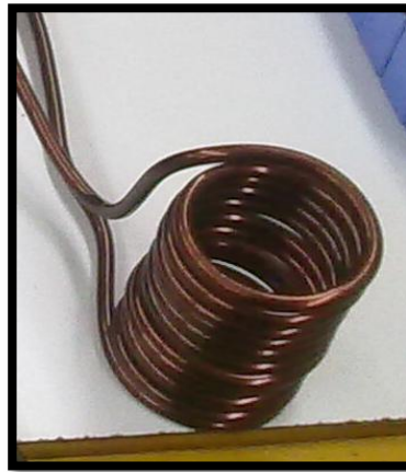
řekil 6.2 İř bobini (2.47 \mu\text{H} )
