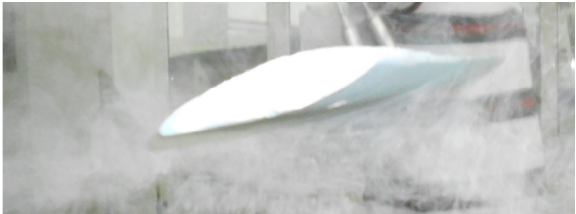
Şekil 4. 15. 10°'lik hücum açısında akım görüntüsü
