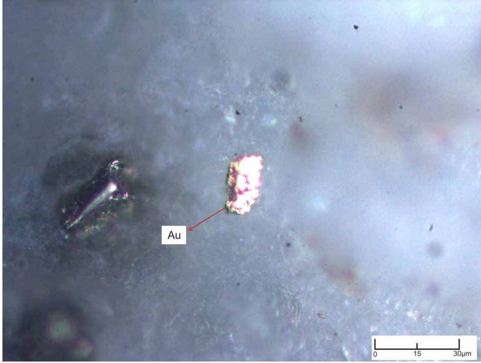
Şekil 3.17. Gang mineralleri içerisinde gözlenen nabit altın (Örnek No: EIC-17, parlatma, Au: Nabit altın)
