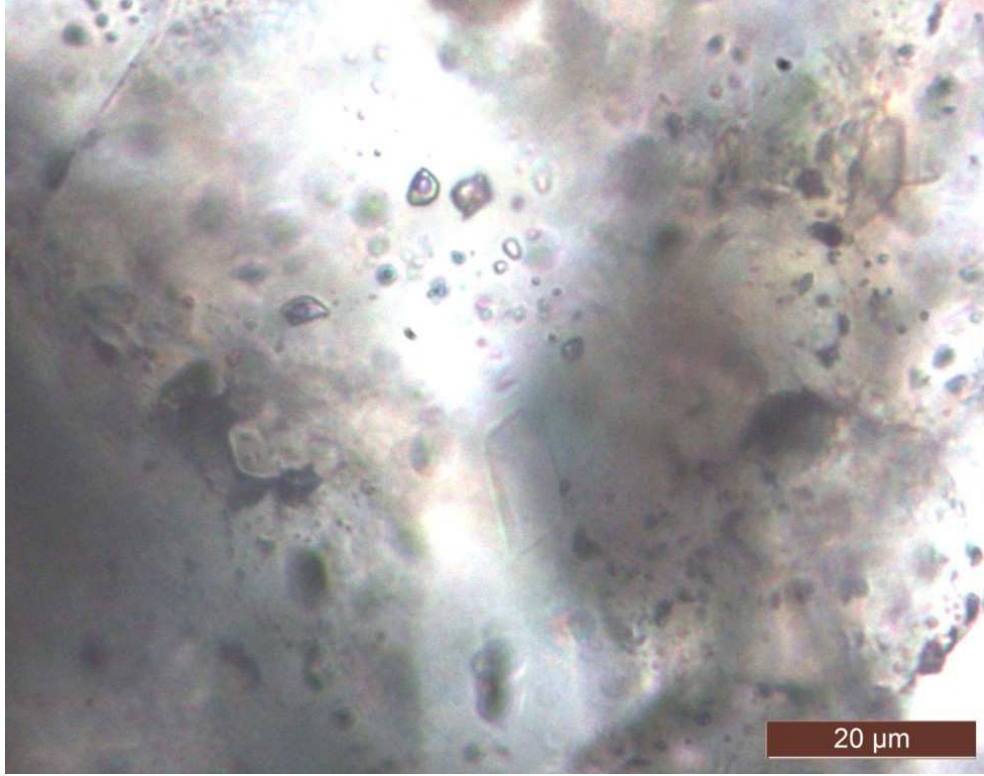
Şekil 4.1. Granitiotik kütle içindeki kuvars damarlarından alınmış bir örnekte kuvars kristalleri içindeki birincil sıvı kapanımları (Örnek No: EIC-36)
