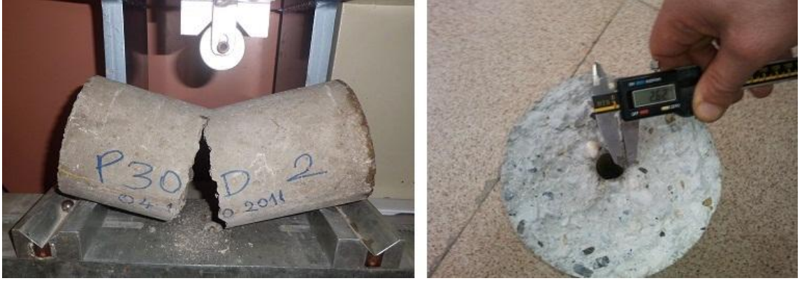
Şekil 3.17. Numunenin kırılması ve su işleme derinliğinin ölçülmesi
