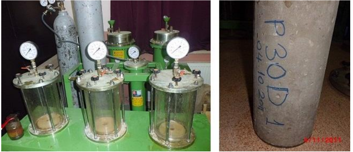
Şekil 3.15. Permeabilite cihazı ve 150x300 mm silindir numune
