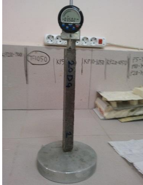
Şekil 3.25. Boy ölçümü yapılan bir harç çubuğu numunesi
