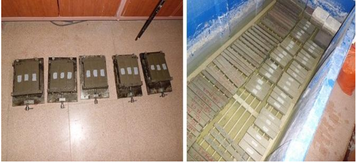
Şekil 3.23. Üretilen 40x40x160 mm harç numuneleri
