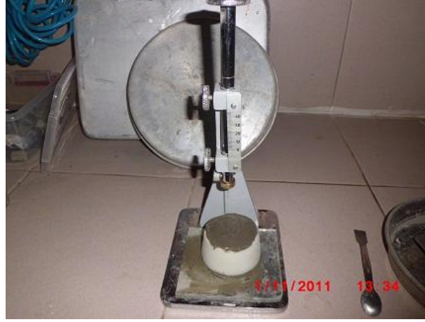
Şekil 3.19. Vicat aleti, iğnesi, priz başlangıç ve bitiş tayini deney numunesi
