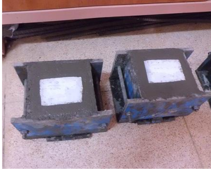
Şekil 3.11. Üretilen 10x10x10 cm beton numuneleri
