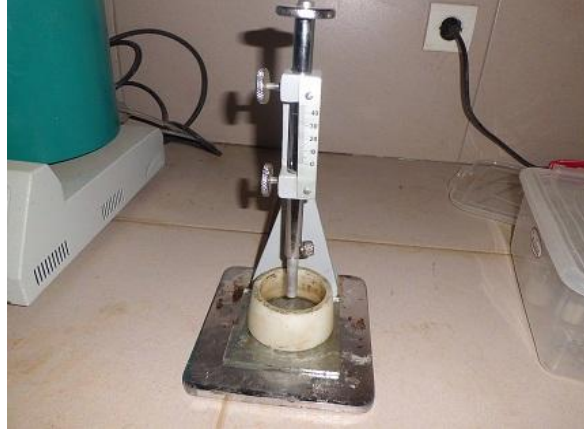
Şekil 3.18. Vicat aleti, normal kıvam tayini için kullanılan sonda ve vicat halkası
