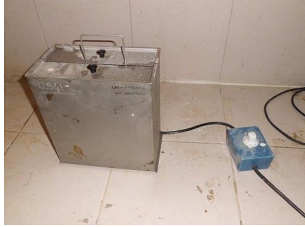
Şekil 3.21. Numunelerin kaynama sıcaklığında bekletildiği deney aleti
