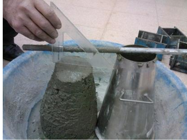
Şekil 3.9. Slump deneyinin yapılışı
