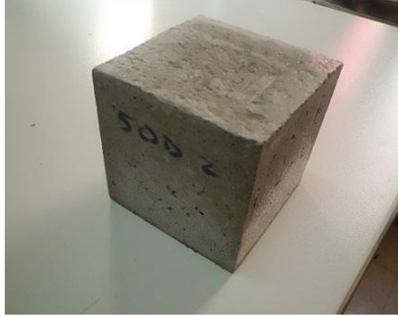
Şekil 3.14. Donma-çözülme etkisine maruz bir numune
