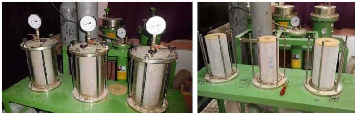
Şekil 3.16. Permeabilite cihazına yerleştirilen ve çıkarılan numuneler
