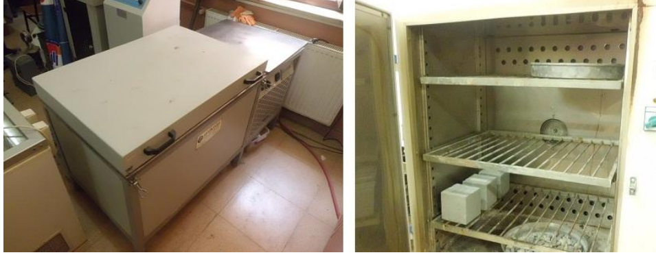
Şekil 3.13. Donma-çözülme cihazı ve numunelerin etüvde kurutulması
