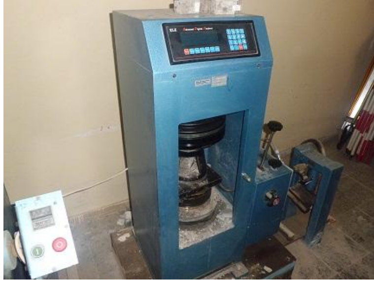
Şekil 3.24. Harçların basınç mukavemeti deneyi cihazı ve numune
