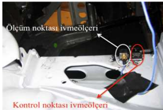
Şekil 3.6 : Ön sağ giriş ölçüm ve kontrol noktaları ivmeölçerleri.
