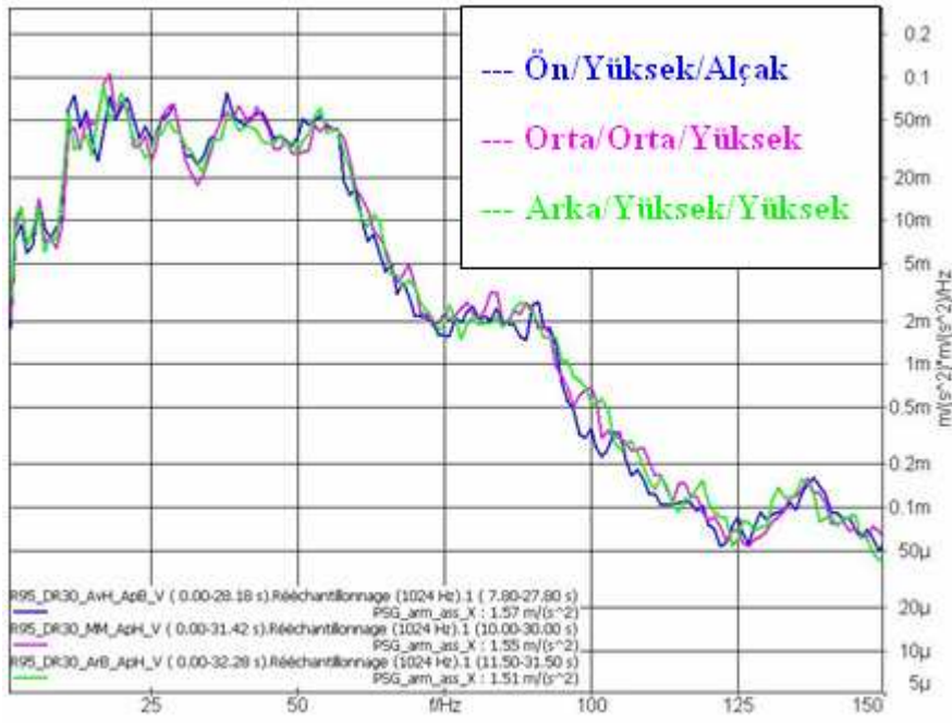
Şekil 2.31 : DR30 Pisti – X Yönü – Farklı pozisyonlardaki koltuk oturağı ivme titreşimlerinin frekansa bağlı değişimi.
