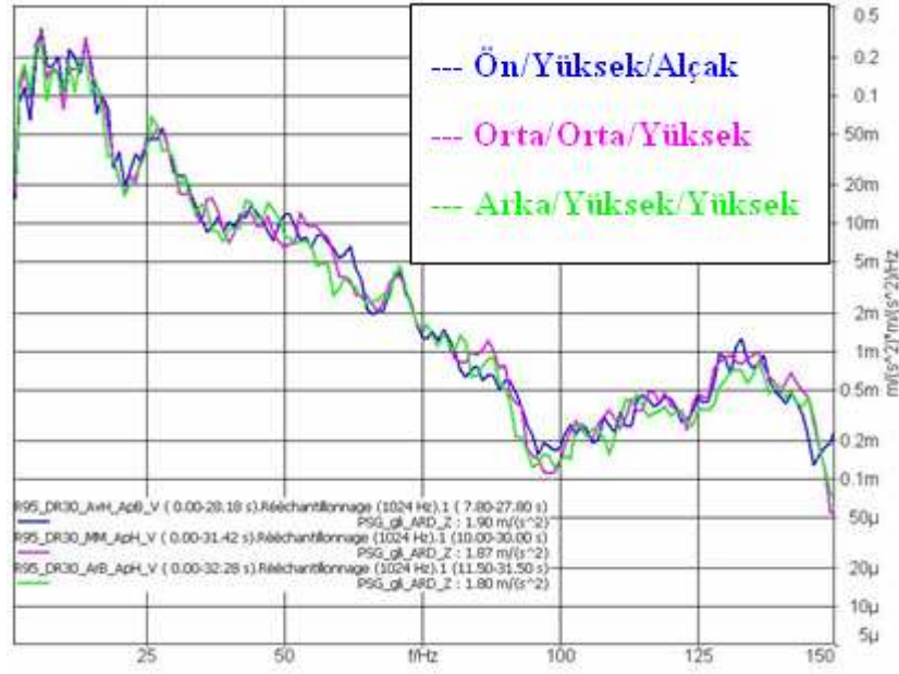
Şekil 2.30 : DR30 Pisti – Z Yönü – Farklı pozisyonlardaki koltuk kazağı ivme titreşimlerinin frekansa bağlı değişimi.
