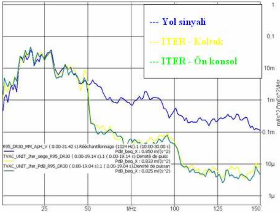
Şekil 3.8 : DR30 – X Yönü – Yol Sinyali / ITER Ön Konsol / ITER Koltuk – frekansa bağlı ivme titreşimleri karşılaştırması.
