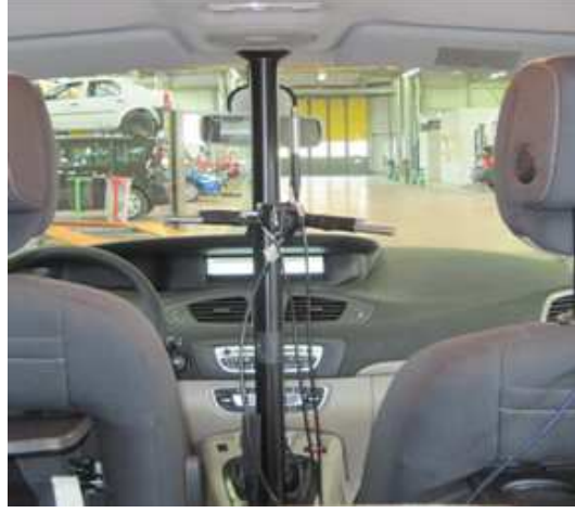
Şekil 3.5 : Mikrofonların kabin içinde yerleşimi.
