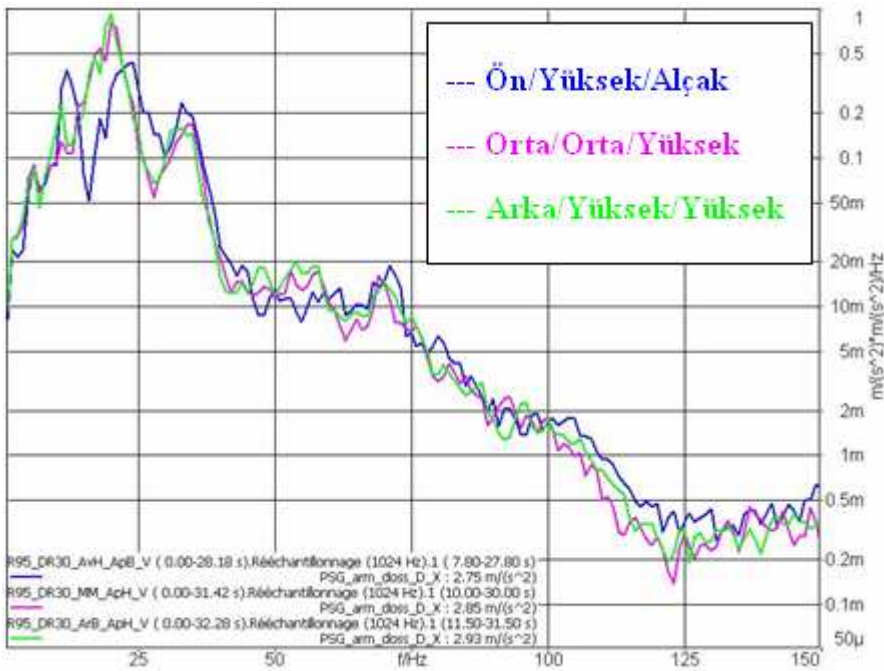
Şekil 2.32 : PS30 Pisti – X Yönü– Farklı pozisyonlardaki koltuk sırtı ivme titreşimlerinin frekansa bağlı değişimi.
