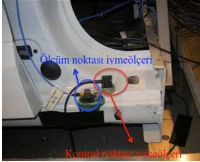
Şekil 3.7 : Sol ön blok alt ayağı ölçüm ve kontrol noktaları ivmeölçerleri.
