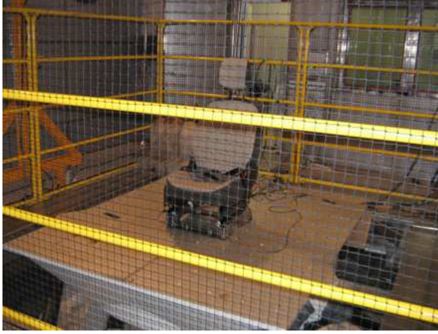
Şekil 3.3 : Çok eksenli sarsıcı üzerine monte edilmiş yolcu koltuğu.
