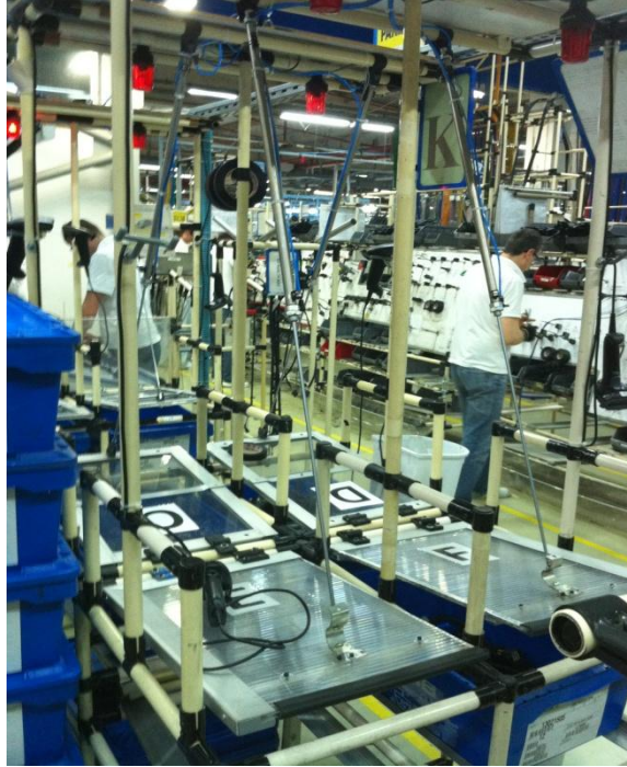
Şekil 3.3 Mevcut küçük palet kapatma sistemleri
