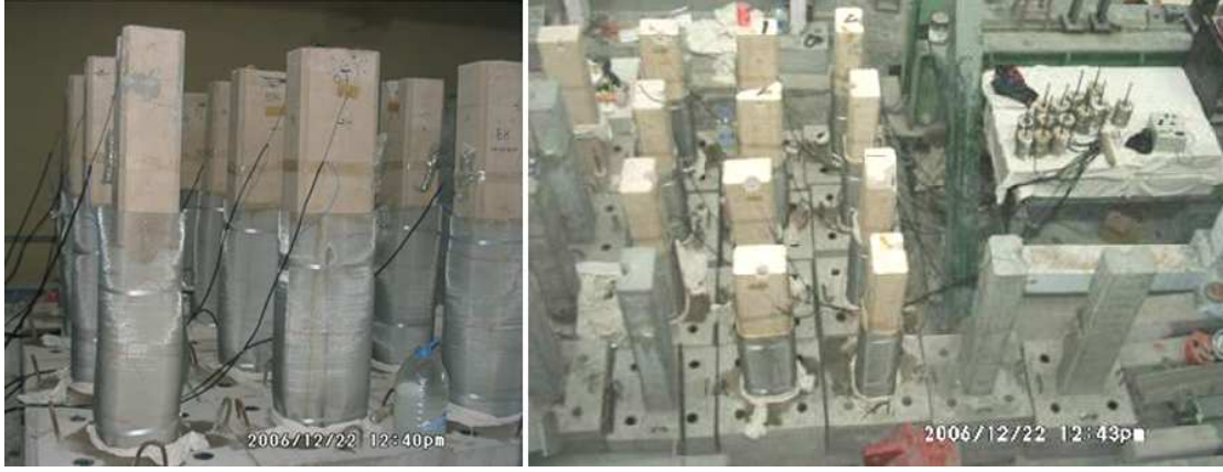
Şekil 4.1 : Hızlandırılmış korozyona tabii tutulan kolon numuneleri
