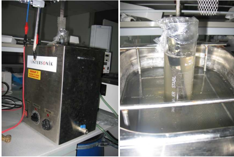
Şekil 4.4 : Donatıların pas ve betondan temizlenmesi işlemi (Göksu, 2011)
