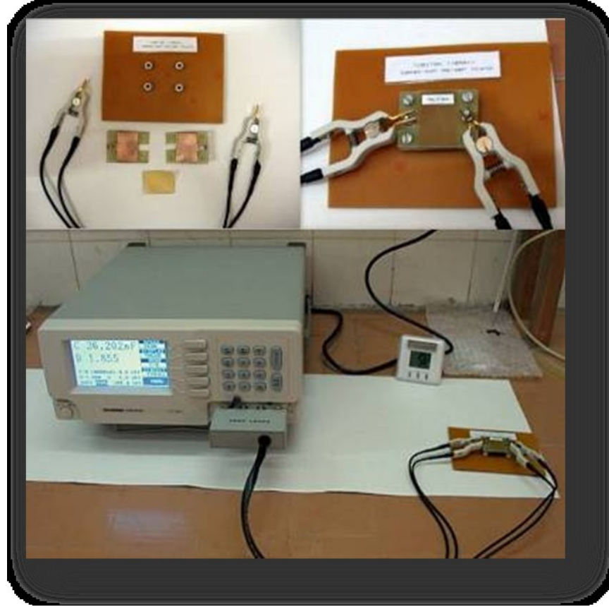
Şekil 3.2 Dielektrik ölçümlerinde kullanılan bakır kaplı elektrodlar, yarı IPN jel (dikdörtgen) film, ölçüm düzeneği, nem-sıcaklık ölçer ve LCR metre
