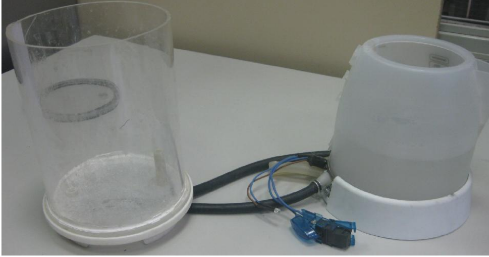
Şekil 3.24 : Flow-through ısıtıcı ile taşıma deney düzeneğinin görünüşü.
