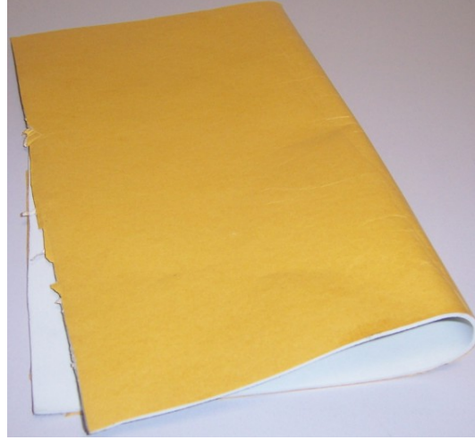
Şekil 6.9 : Tek yüzü yapışkan gıdaya uygun EPDM conta numunesi.
