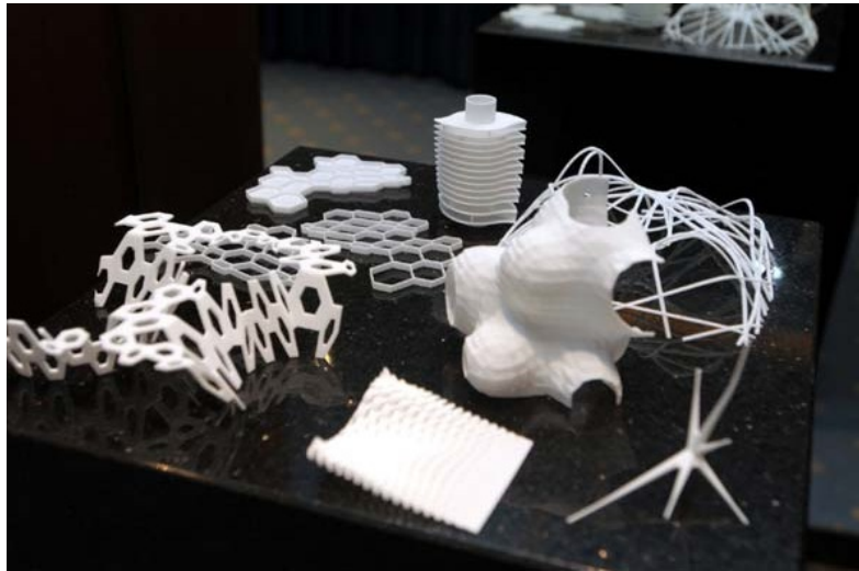
Şekil 3.5 : SLS teknolojisiyle üretilmiş bazı parçalar.
