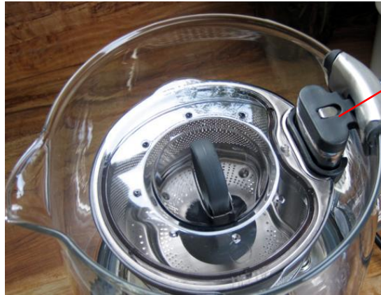
Şekil 4.9 : Breville süzgeç hareket mekanizması.
