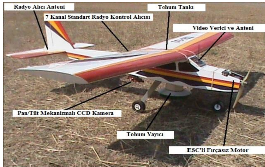
Şekil 4.6. Aviyonik ve mekanik parçaların İHA üzerindeki yerleşimi.
