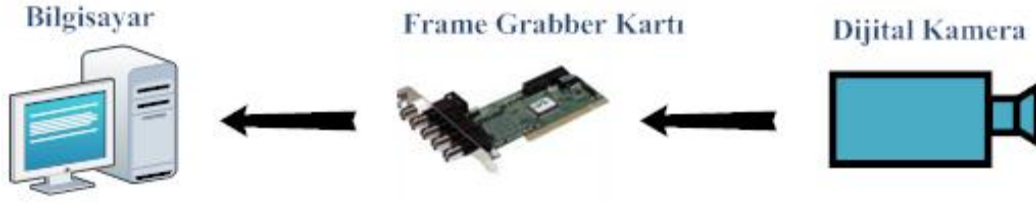
Şekil 3.2 Görüntü Alma Blok Diyagramı
