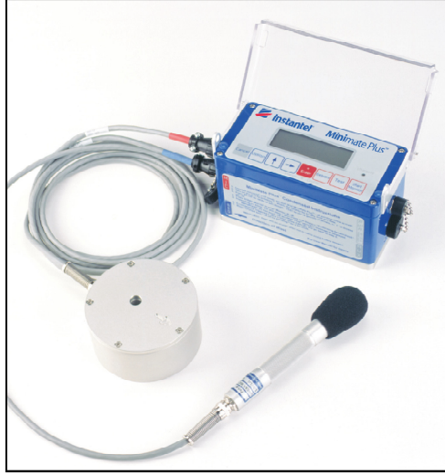
Şekil 6.2. Patlatma titreşimlerini kaydetmek için kullanılan kayıtçı, 3-bileşenli jeofon ve mikrofon sistemi
