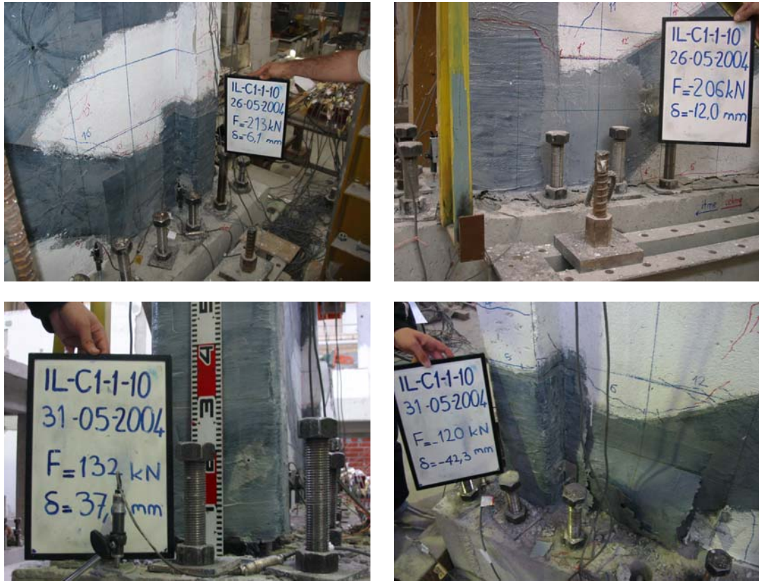
řekil 5.15 : IL-C1'in ilk deneyindeki hasar durumu.
