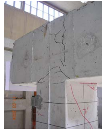
Şekil 4.16 : ‘Dolgu Duvarsız Numune 1’in \pm 3.5 mm (a), \pm 4.2 mm (b) ve \pm 10.5 mm (c) yerdeğiştirme adımlarındaki hasar durumu.
