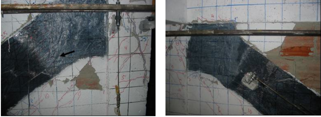
Şekil 4.37 : Numune N3'ün -14 mm yerdeğiştirme adımının üçüncü çekme çevrimindeki hasar durumu.
