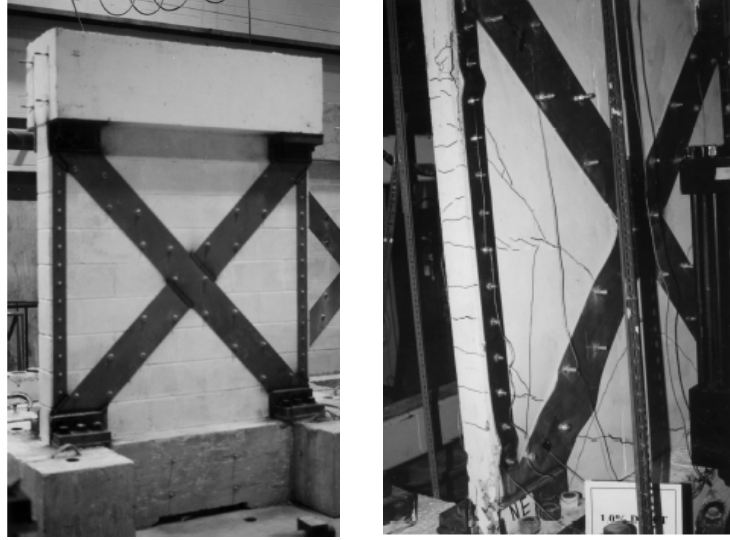
Şekil 2.5 : Çelik plakalar ile güçlendirilmiş yığma duvar numunesi ve göçme şekli, (Taghdi ve diğ., 2000).
