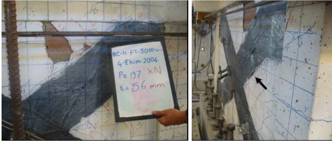
Şekil 4.32 : Numune N3'ün \pm 5.6 mm yerdeğiştirme adımındaki hasar durumu.
