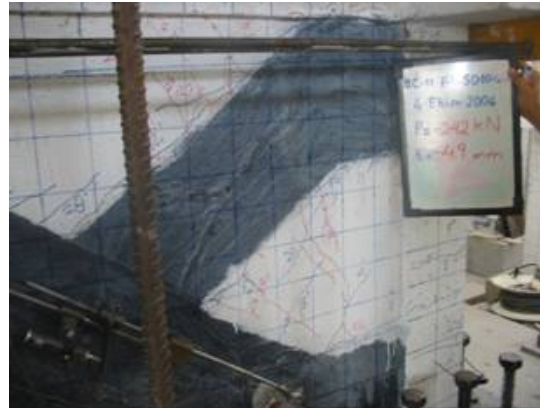
Şekil A.32 : Numune N3'ün \pm 4.9 mm yerdeğiştirme adımındaki hasar durumu.
