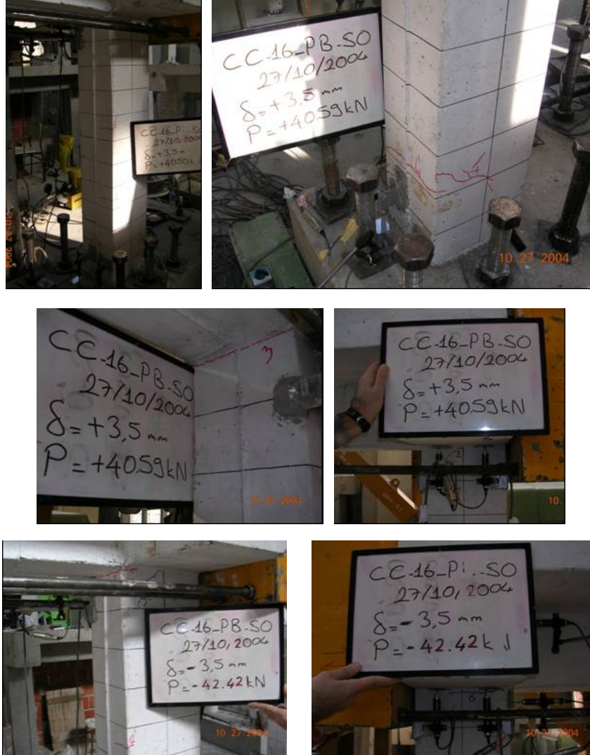
Şekil A.16 : ‘Dolgu Duvarsız Numune 1’in \pm 3.5 \text{ mm} yerdeğiştirme adımındaki hasar durumu.
