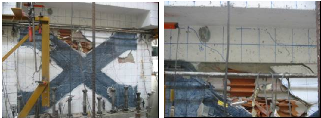
Şekil A.35 : Numune N3'te +28 mm yerdeğiştirme adımının ilk itme çevrimindeki hasar durumu.
