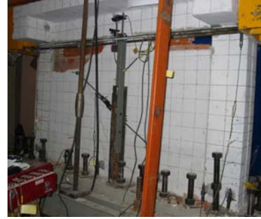
Şekil A.25 : Numune N1'in \pm 10.5 mm yerdeğiştirme adımının ilk (a) ve sonraki çevrimlerindeki (b) hasar durumu.
