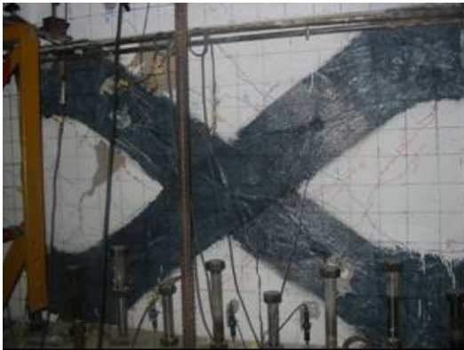
Şekil A.33 : Numune N3'ün - 10.5 mm yerdeğiştirme adımının üçüncü çekme çevriminde hasar durumu.
