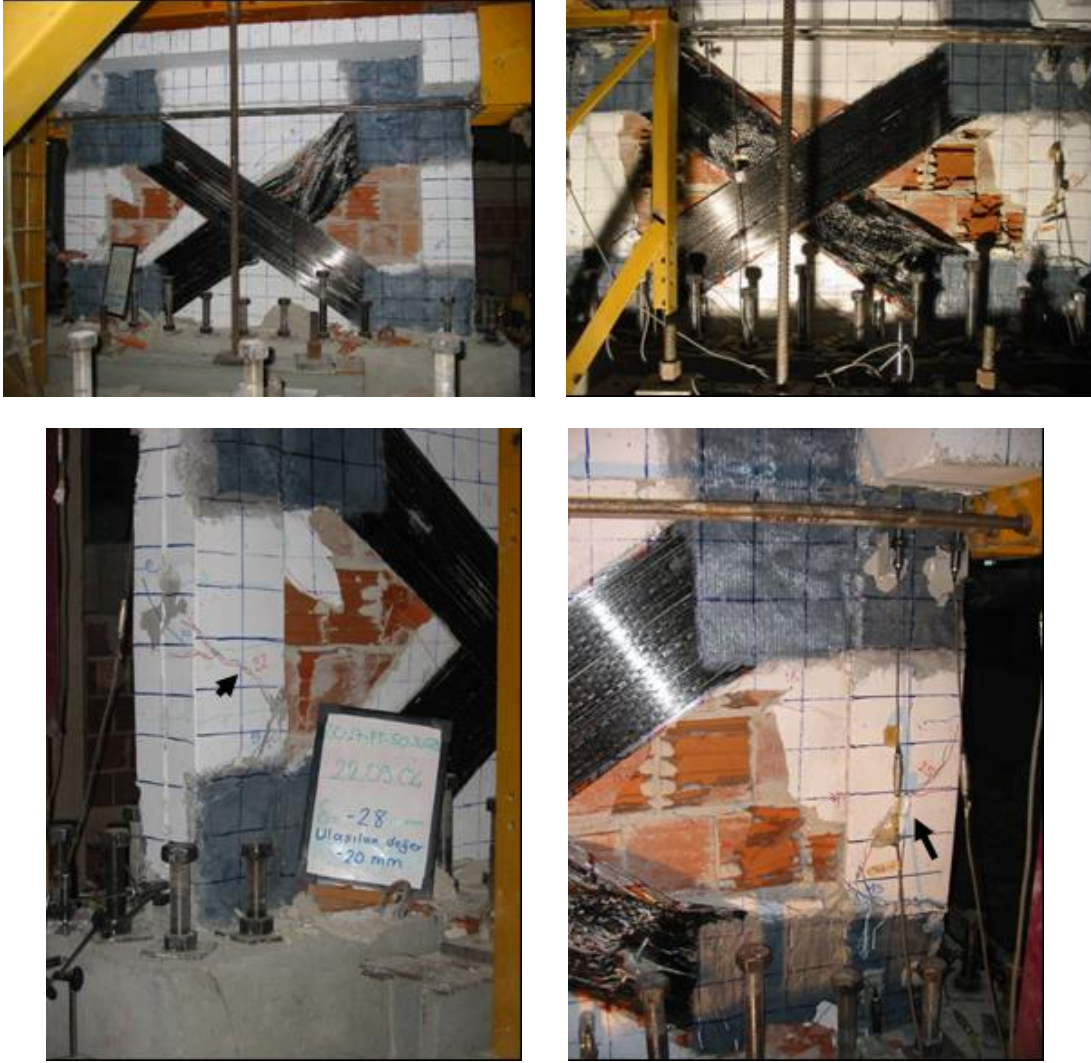
Şekil 4.46 : Numune N4'ün göçme şekli.
