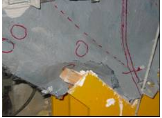
Şekil A.4 : Tüm yüzü CFRP kaplı sıvasız numune S7'nin göçme şekli.
