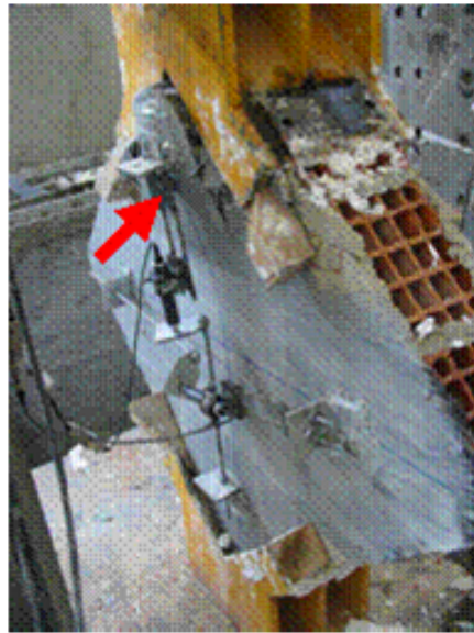
Şekil A.7 : 300 mm genişlikte CFRP ile güçlendirilmiş sıvalı üçüncü grup numunesi S29'un göçme şekli.
