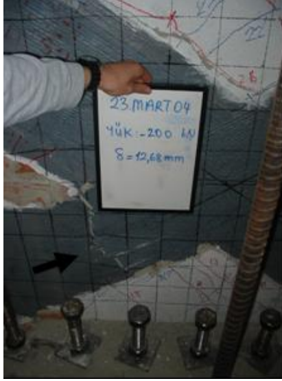
Şekil A.30 : Numune N2’de +11.64 mm yerdeğiştirme değerinde dolgu duvar üzerindeki CFRP’nin kopması.
