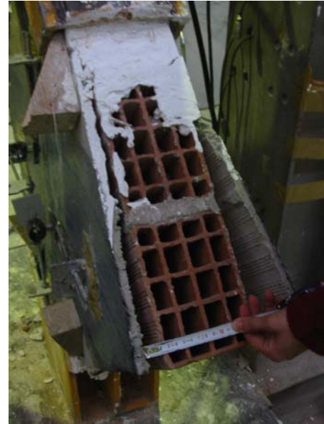
Şekil A.9 : 300 mm genişlikte CFRP ile güçlendirilmiş sıvalı ikinci grup numunesi S10'un göçme şekli.
