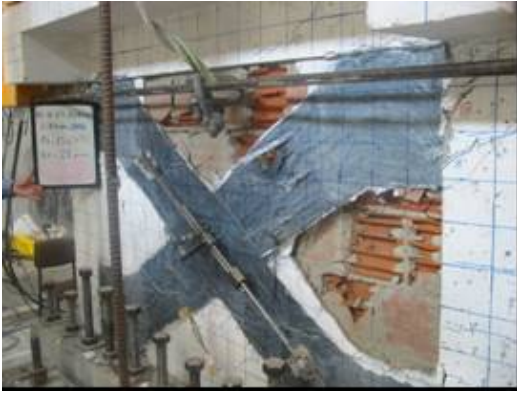
Şekil A.36 : Numune N3'te -28 mm yerdeğiştirme adımının ilk çekme çevriminde hasar durumu.
