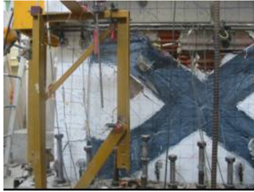
Şekil A.36 : Numune N3'te -28 mm yerdeğiştirme adımının ilk çekme çevriminde hasar durumu.
