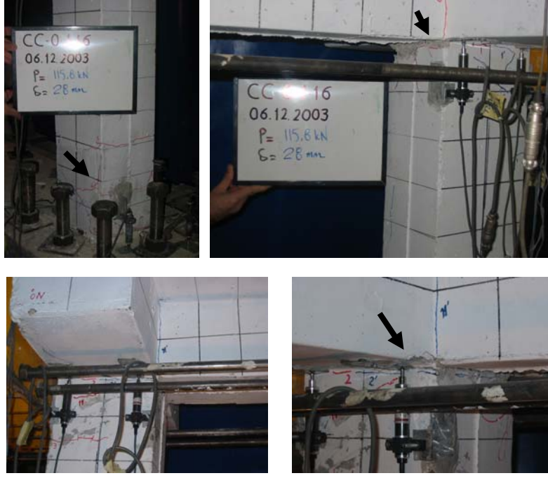
Şekil A.22 : ‘Dolgu Duvarsız Numune 2’nin \pm 28 mm yerdeğiştirme adımındaki hasar durumu.
