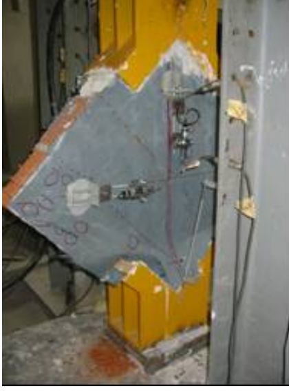
Şekil A.4 : Tüm yüzü CFRP kaplı sıvasız numune S7'nin göçme şekli.
