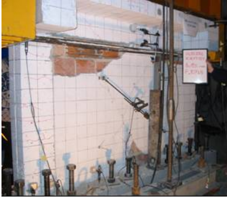
Şekil A.25 : Numune N1'in \pm 10.5 mm yerdeğiştirme adımının ilk (a) ve sonraki çevrimlerindeki (b) hasar durumu.
