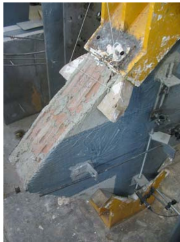
Şekil 3.22 : 300 mm genişlikte CFRP ile güçlendirilmiş ankrajlı sıvalı numune S21'in göçme şekli.
