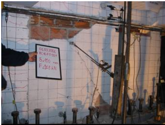
Şekil A.26 : Numune N1'in \pm 11 mm yerdeğiştirme adımındaki hasar durumu.
