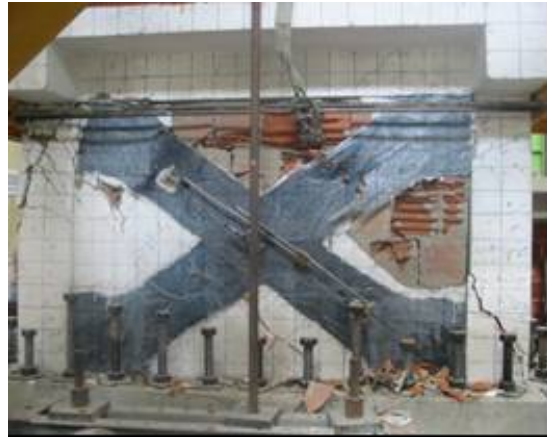
Şekil 4.38 : Numune N3'ün +28 mm yerdeğiştirme adımının ilk itme çevrimindeki hasar durumu.
