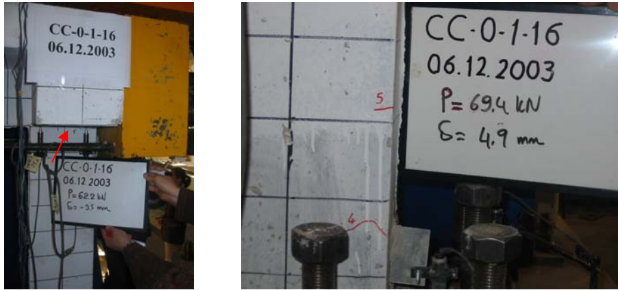
Şekil A.19 : ‘Dolgu Duvarsız Numune 2’nin \pm 3.5 mm ve \pm 4.9 mm yerdeğiştirme adımlarındaki hasar durumu.
