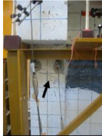
Şekil 4.30 : Numune N3’ün \pm 1.4 mm yerdeğiřtirme adımımdaki hasar durumu.
