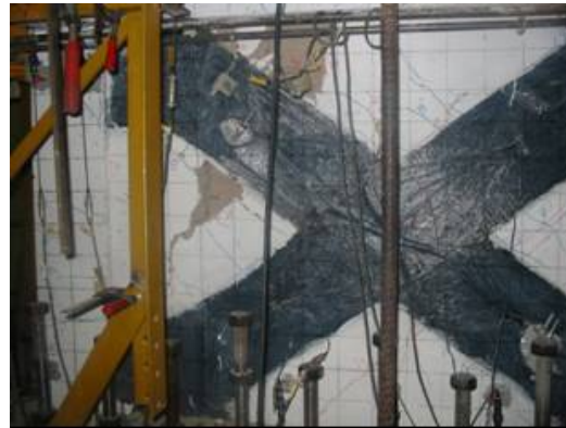
Şekil A.33 : Numune N3'ün - 10.5 mm yerdeğiştirme adımının üçüncü çekme çevriminde hasar durumu.
