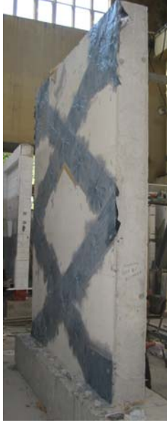
Şekil 5.7 : İki katlı-tek açıklıklı betonarme çerçeve numunelerinde tek yüze CFRP uygulaması ‘C2’.
