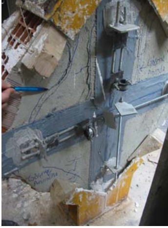
Şekil A.12 : 150 mm genişlikte CFRP ile güçlendirilmiş sıvalı numune S24r'nin göçme şekli.
