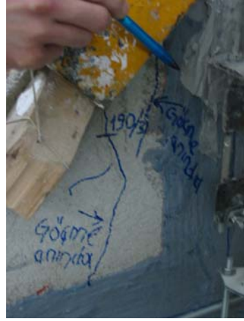
Şekil A.12 : 150 mm genişlikte CFRP ile güçlendirilmiş sıvalı numune S24r'nin göçme şekli.
