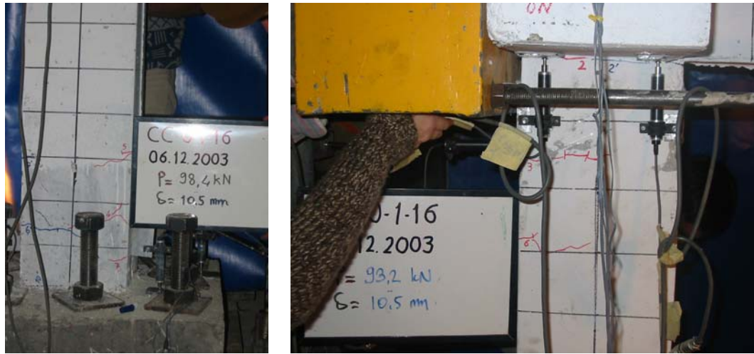
Şekil A.20 : ‘Dolgu Duvarsız Numune 2’nin \pm 10.5 mm yerdeğiştirme adımındaki hasar durumu.
