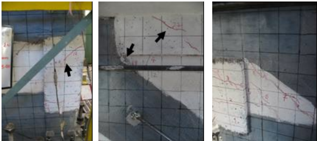
Şekil 4.24 : Numune N2'nin \pm 3.5 mm yerdeğiřtirme adımındaki hasar durumu.
