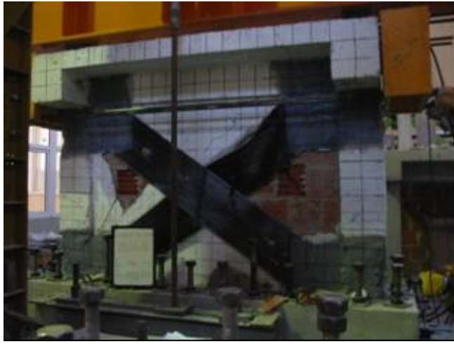
Şekil 4.45 : Numune N4'ün +14 mm yerdeğiştirme adımının üçüncü itme çevrimindeki hasar durumu.
