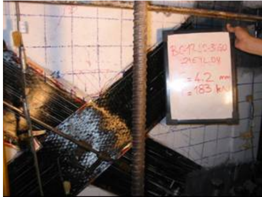
Şekil A.37 : Numune N4'ün \pm 4.2 mm yerdeğiştirme adımındaki hasar durumu.
