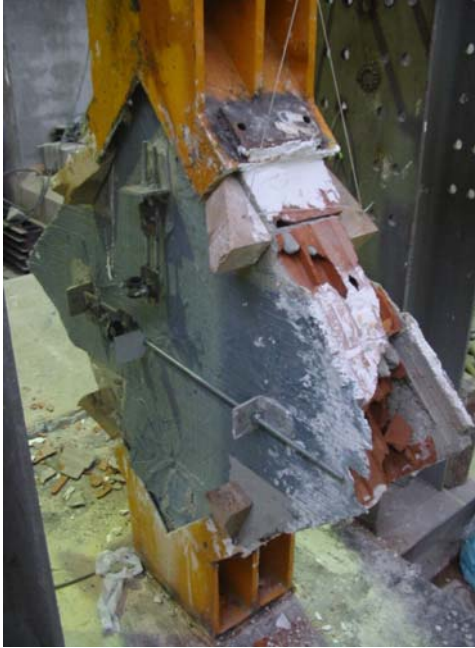
Şekil A.8 : 300 mm genişlikte CFRP ile güçlendirilmiş sıvalı ikinci grup numunesi S21 (a) ve S21r'nin (b) göçme şekilleri.
