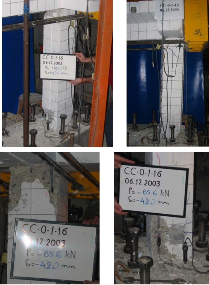
Şekil 4.19 : ‘Dolgu Duvarsız Numune 2’nin \pm 42 mm yerdeğiştirme adımındaki hasar durumu.
