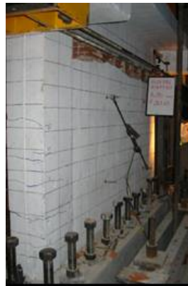
Şekil A.26 : Numune N1'in \pm 11 mm yerdeğiştirme adımındaki hasar durumu.
