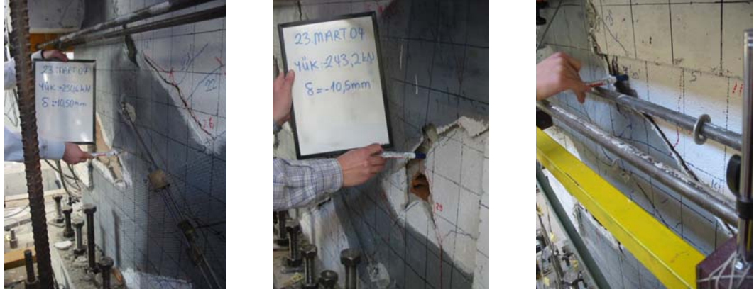
řekil 4.26 : Numune N2'nin \pm 10.5 mm yerdeęiřtirme adımımdaki hasar durumu.
