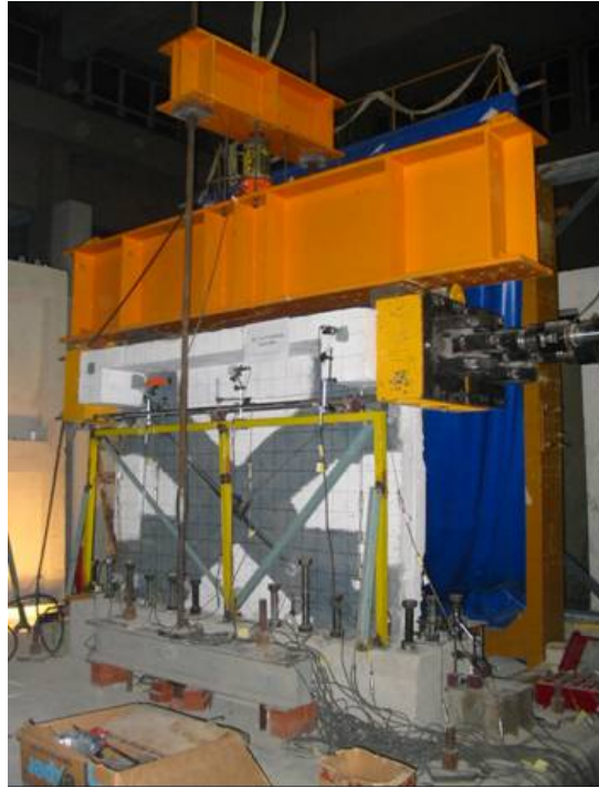
Şekil 4.8 : Tek katlı-tek açıklıklı betonarme çerçevelerin deney düzeneği.
