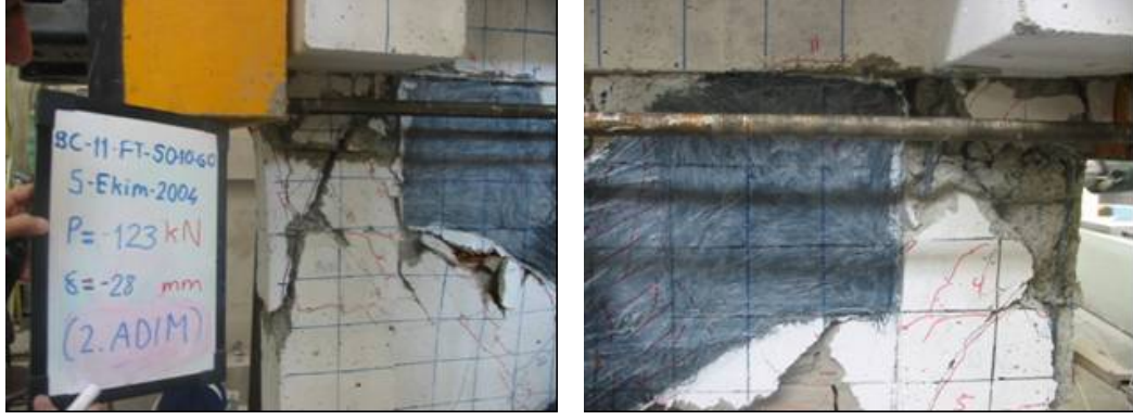
Şekil 4.40 : Numune N3'ün -28 mm yerdeğiştirme adımının ikinci çekme çevrimindeki hasar durumu.
