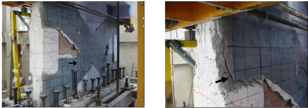
řekil 4.27 : Numune N2'de +11.64 mm yerdeęiřtirme deęerinde dolgu duvar  zerindeki CFRP'nin kopması.
