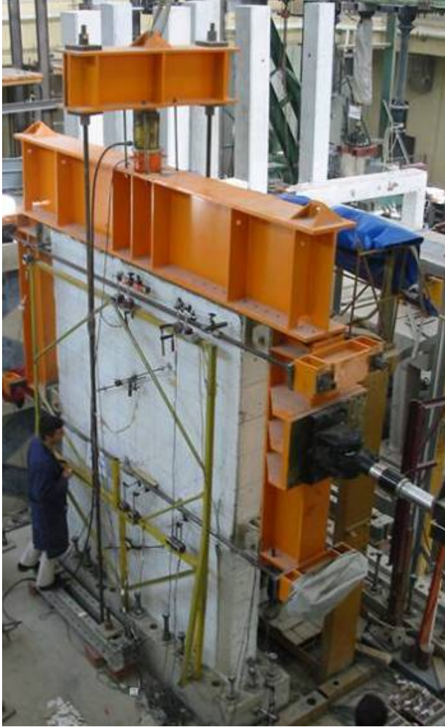
Şekil 5.8 : İki katlı-tek açıklıklı betonarme çerçeve deneyi yükleme ve ölçüm düzeneği.
