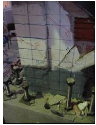
Şekil 4.45 : Numune N4'ün +14 mm yerdeğiştirme adımının üçüncü itme çevrimindeki hasar durumu.
