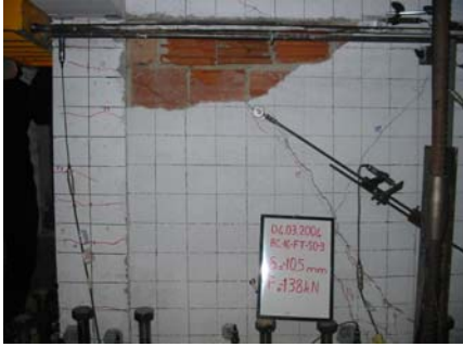
Şekil A.25 : Numune N1'in \pm 10.5 mm yerdeğiştirme adımının ilk (a) ve sonraki çevrimlerindeki (b) hasar durumu.
