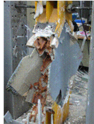
Şekil 3.21 : 300 mm genişlikte CFRP ile güçlendirilmiş sıvalı numuneler S5'in (a), S29'un (b) ve S33'ün (c) göçme şekilleri.
