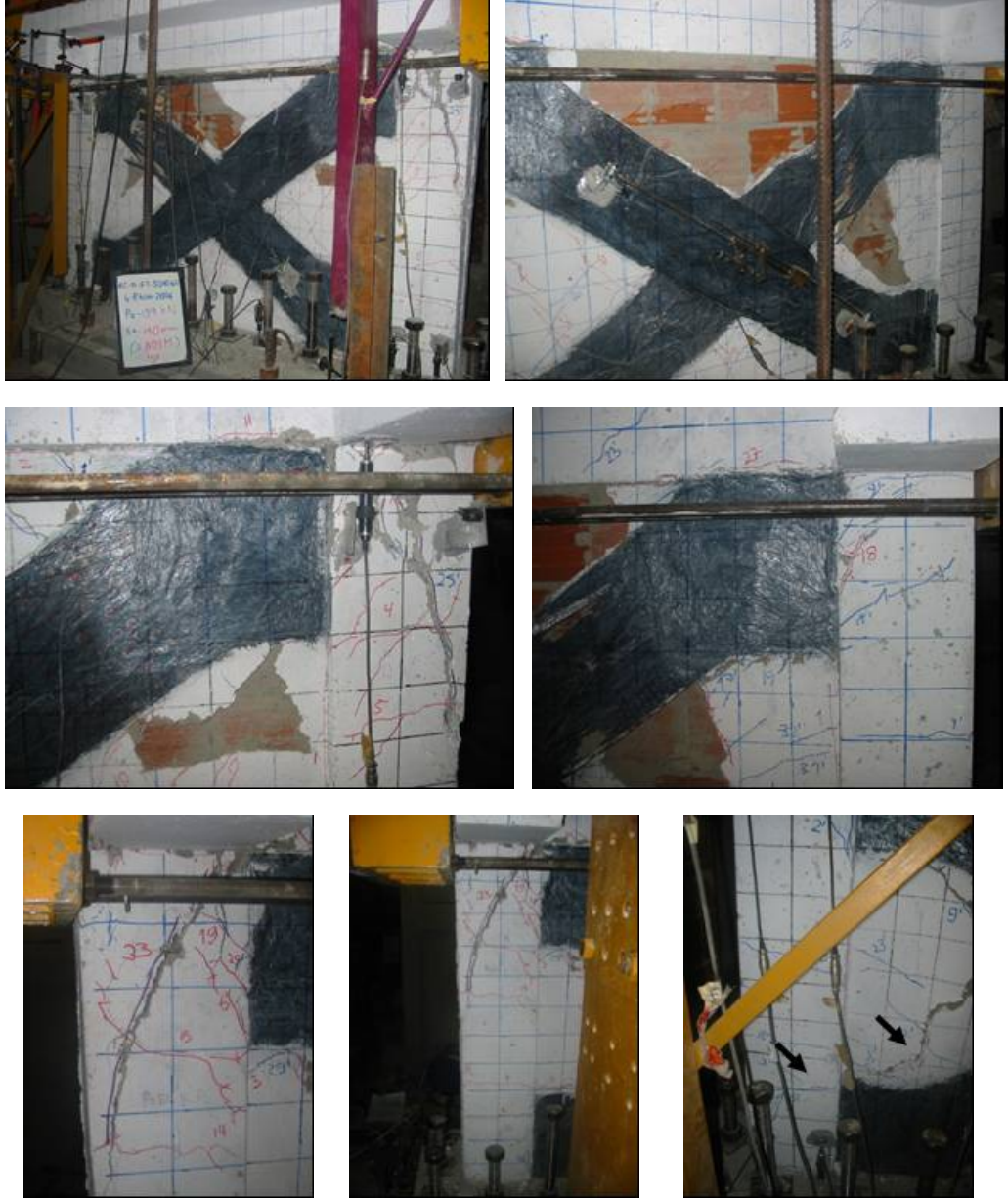
Şekil A.34 : Numune N3'ün 14 mm yerdeğiştirme adımının üçüncü itme çevrimindeki hasar durumu.
