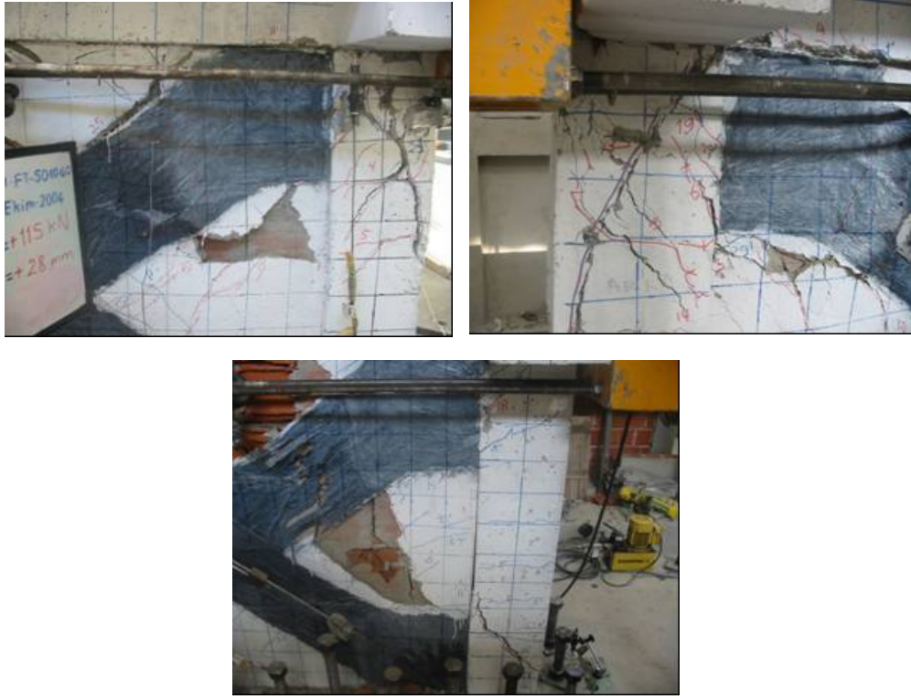
Şekil 4.38 : Numune N3'ün +28 mm yerdeğiştirme adımının ilk itme çevrimindeki hasar durumu.
