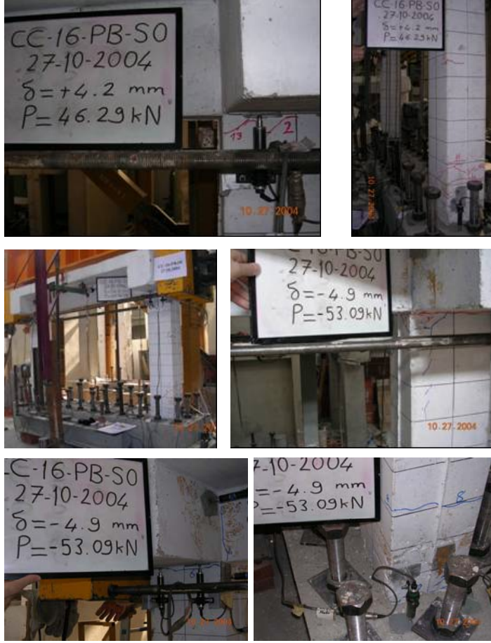
Şekil A.17 : ‘Dolgu Duvarsız Numune 1’in \pm 4.2 \text{ mm} ve \pm 4.9 \text{ mm} yerdeğiştirme adımlarındaki hasar durumu.
