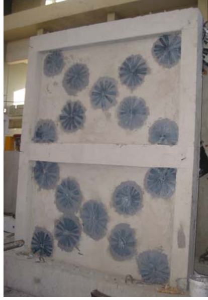
Şekil 5.7 : İki katlı-tek açıklıklı betonarme çerçeve numunelerinde tek yüze CFRP uygulaması ‘C2’.
