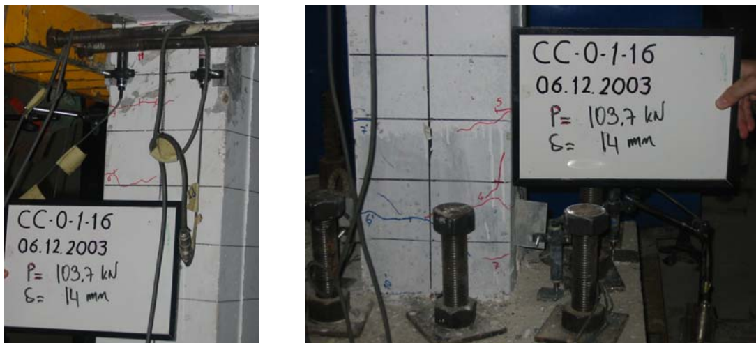
Şekil A.21 : ‘Dolgu Duvarsız Numune 2’nin \pm 14 mm yerdeğiştirme adımındaki hasar durumu.
