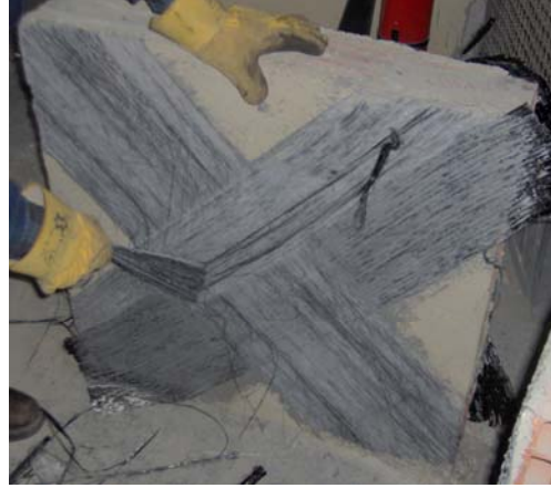
Şekil 3.9 : Üçüncü grup dolgu duvar numunesi S29'un ilk güçlendirilmesi.
