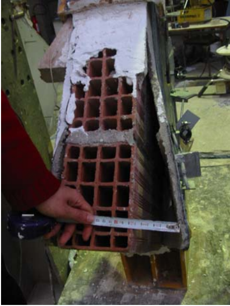
Şekil A.9 : 300 mm genişlikte CFRP ile güçlendirilmiş sıvalı ikinci grup numunesi S10'un göçme şekli.
