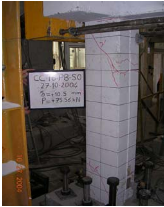
Şekil 4.16 : ‘Dolgu Duvarsız Numune 1’in \pm 3.5 mm (a), \pm 4.2 mm (b) ve \pm 10.5 mm (c) yerdeğiştirme adımlarındaki hasar durumu.
