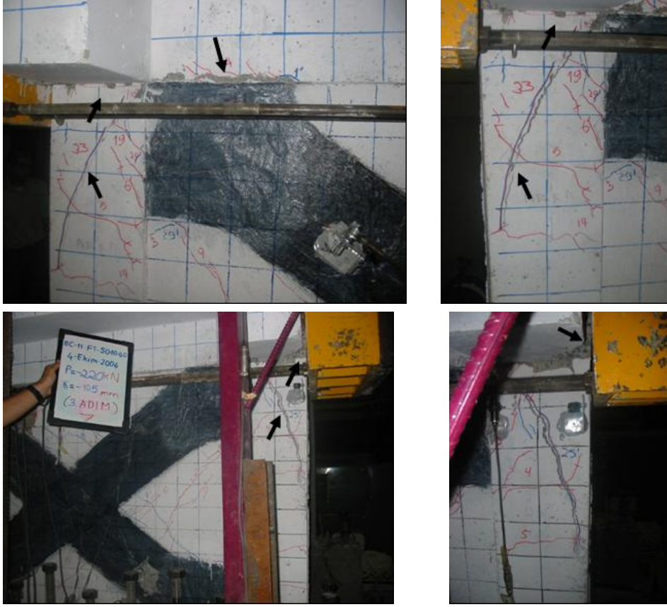
Şekil 4.35 : Numune N3'ün -10.5 mm yerdeğiştirme adımının ilk çekme çevriminde hasar durumu.
