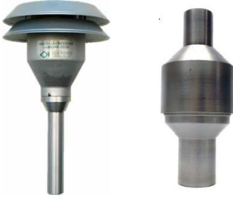
Şekil 3.3: Cihazda PM_{10} ve PM_{2.5} örneklemeleri için kullanılan başlıklar
