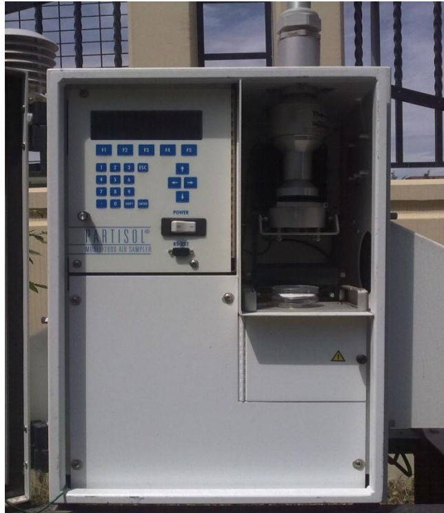
Şekil 3.2: Partisol-FRM MODEL 2000 AIRSAMPLER cihazı
