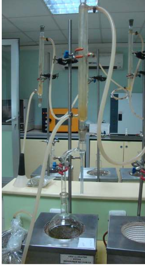
Şekil 3.4. Nem distilasyon aparatı (Kütaş Lab)
