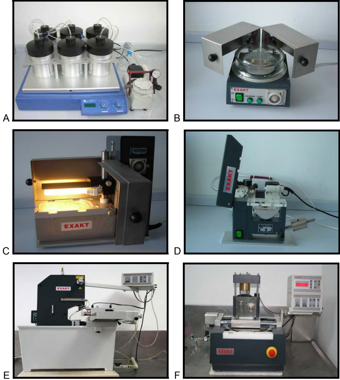
Şekil 3.4. Kesme-İnceltme yönteminde kullanılan cihazlar. A: Vakumlu dehidratasyon ve infiltrasyon ünitesi, B: Vakumlu ve ışıklı reinfiltrasyon ünitesi, C: Polimerizasyon ünitesi, D. Vakumlu ve ışıklı yapıştırma sistemi, E: Hassas kesme sistemi, F: Mikro aşındırma sistemi.
