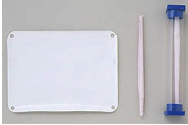
Şekil 5.4 : Kullanılan membranın boyutu (16,4 x 9,5 cm).
