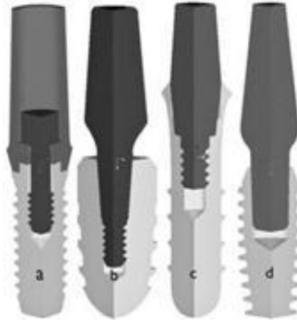
Şekil 2.1. İmplant dayanak bağlantı şekilleri; a) eksternal altıgen, b) morse taper, c) internal altıgen, d) locking taper (soğuk kaynak).
