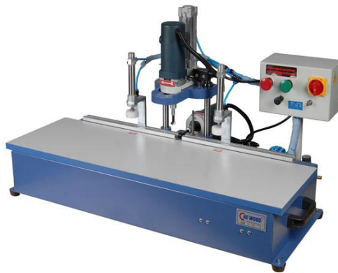
Resim 10. Dikey Delik Makinesi
