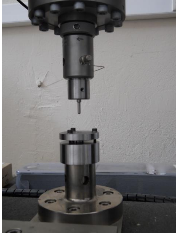
Şekil 17. Deneylerde kullanılan Erichsen kalıp sisteminin resmi.
