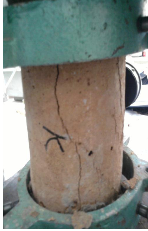
Şekil 3.22 : silindir numunede çatlak oluşumu
