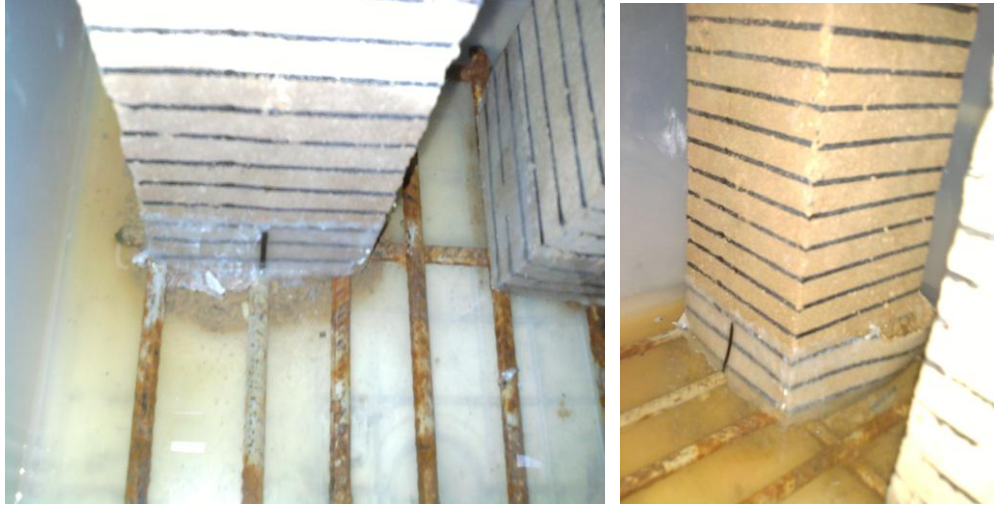
Şekil 5.7 : %10 Alçı numunenin 60.dakikadan sonra çökmesi
