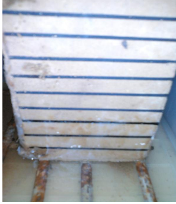
Şekil 5.9 : %10 Alçı , %2.5 Kireç numune
