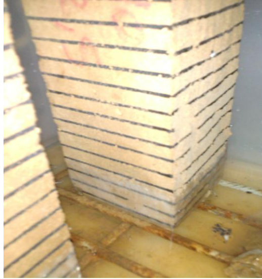
Şekil 5.11 : %10 Alçı , %5 Kireç numune
