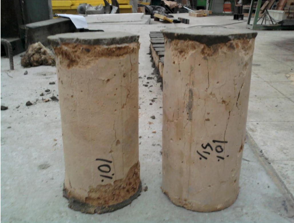
Şekil 3.23: Silindir numunelerde çatlaklar
