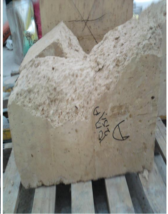
Şekil 3.39 : Numunenin kayma sonrası
