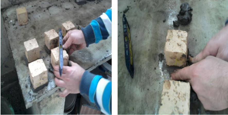
řekil 3.18 : Numunelerde alt ve st bařlık yapılması
