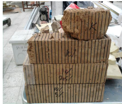
Şekil 5.12 : Numunelerde boyut değişimi Şekil 5.13 : Numunelerin son boyutları
