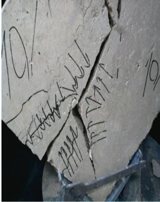
Şekil 3.38 : Numunede Kayma oluşumu
