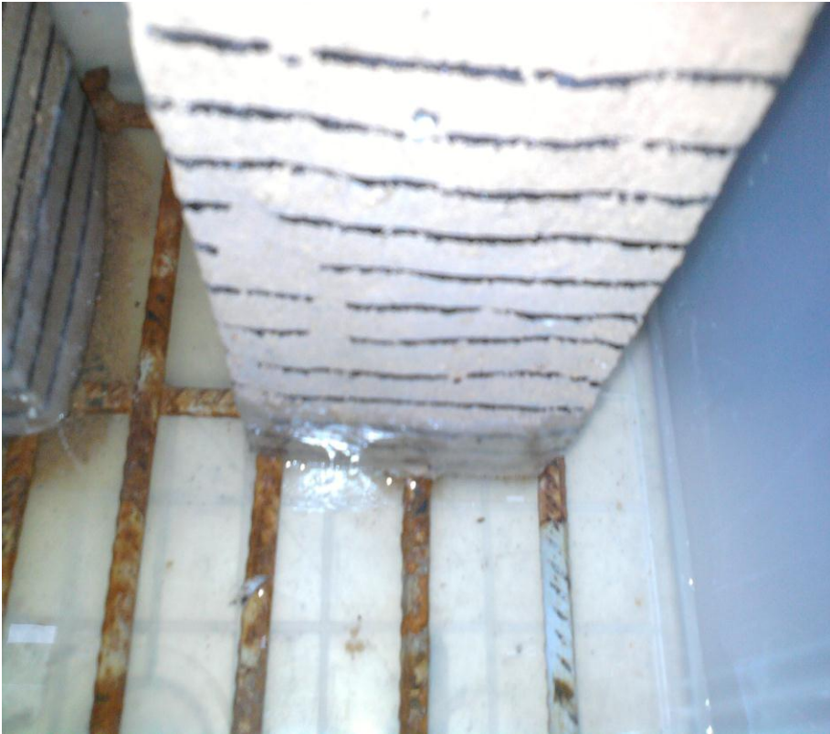
Sekil 5.6 : %10 Alçılı numunenin 60.dakikadan önce çökmesi
