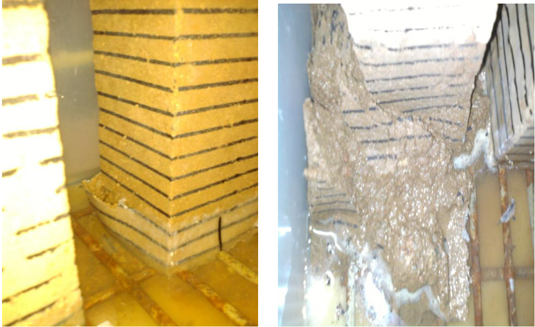
Şekil 5.4 : Katkısız numunenin çökmesi
