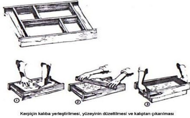
Şekil 2.20 : Kerpiğin kalıba yerleştirilmesi, yüzeyinin düzeltilmesi ve kalıptan çıkarılması.
