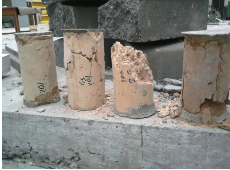
Şekil 3.24 : Silindirlerin kırılma şekli
