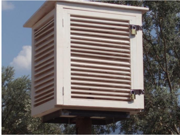
Şekil 3.6. Sıcaklık ve Nem Ölçer Cihazının İçinde Bulunduğu Meteoroloji İstasyonunun Yakından Görünümü.
