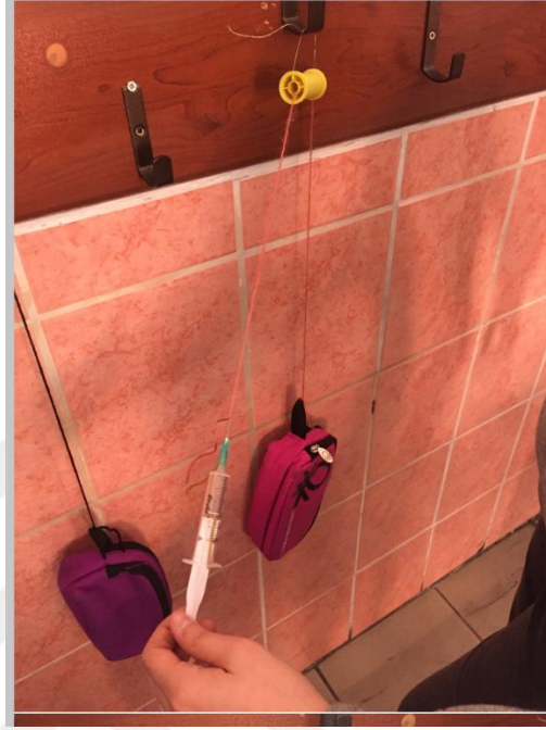
Şekil 3.1: Sabit ve hareketli makara etkinliğine ait çalışmadan fotoğraflar.
