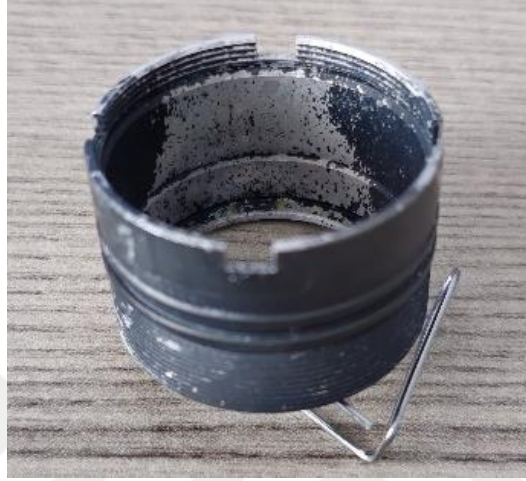
řekil 3. 16: Askı Tasarımlarının, Makro Grntmlerine Etkisi Titanyum Kablo ile Baęlanmıř Numune 3 A/dm 2 - 15 Dakika
