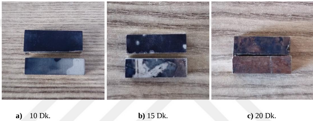
Şekil 3. 4: Test Öncesi ve Sonrası Makro Görüntüler, 2 A/dm 2 a) 10 Dk. b) 15 Dk. c) 20 Dk.
