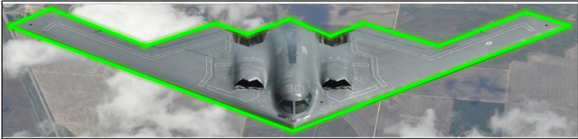
Şekil 2.6. B-2 Spirit uçağının platform tasarımı
