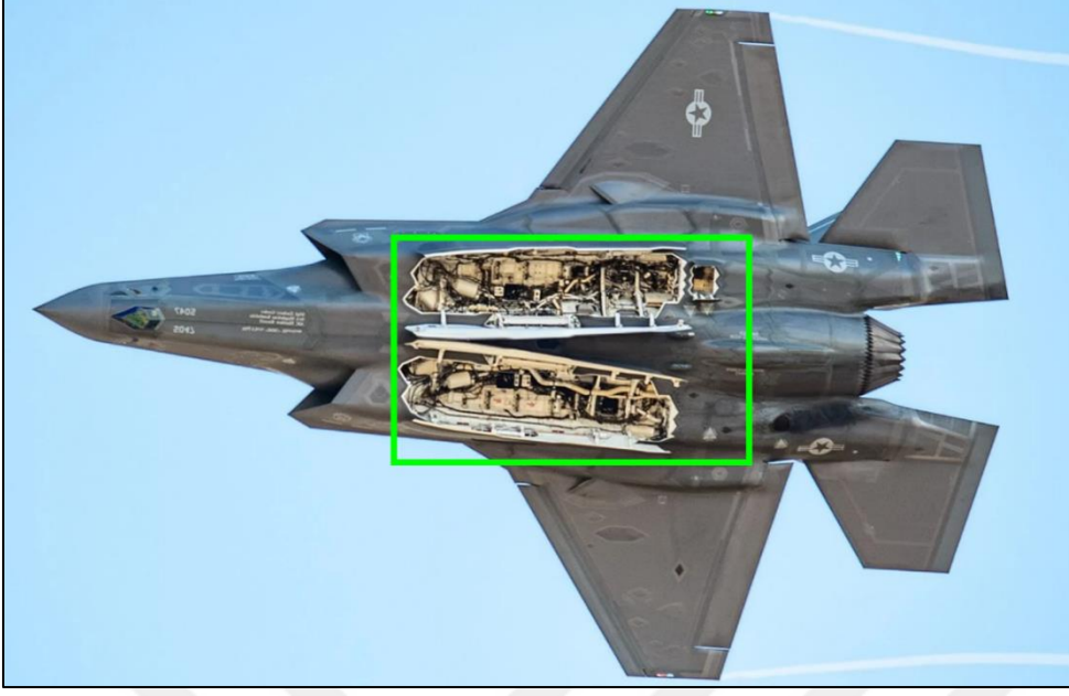
Şekil 2.7. F-35 Gövde içi mühimmat taşıyan silah kapakları
