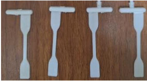
Şekil 4.3: Saf ve %4,%8 ve %16 Bambu elyaf takviyeli YYPE kompozit çekme test numuneleri.
