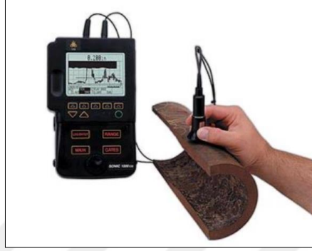
Şekil 3.46 Doğrudan temas ile kalınlık ölçümü (Milli Eğitim Bakanlığı, 2012)
