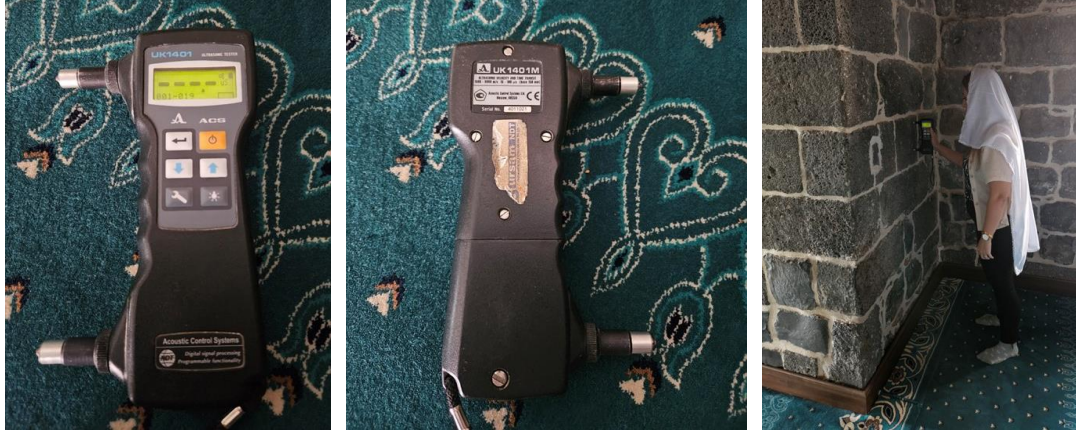
Şekil 4.56 Düşük frekanslı ultrasonik test cihazı yapılan ölçüm (2024)
