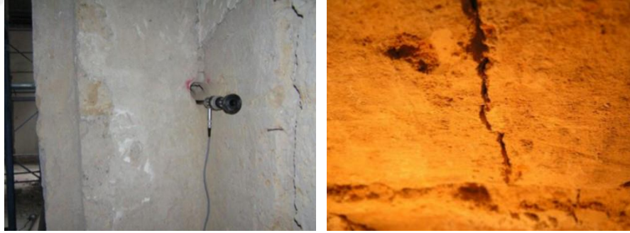
Şekil 3.73 Tarihi yapıda endoskopi yönteminin uygulanması ve elde edilen görüntü (Bianco, 2012)
