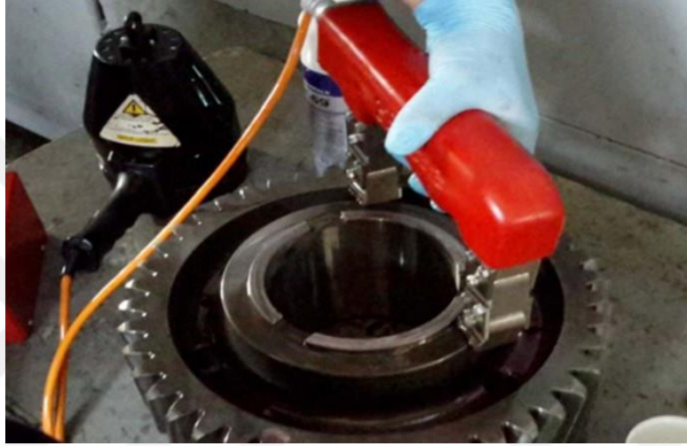
Şekil 3.39 Yoke cihazı ve manyetik toz ile çatlak tespiti (Haliloğlu, 2016)
