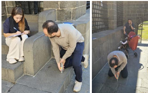
Şekil 4.64 Hz. Süleyman (Kale) Cami’de Schmidt çekici ile sertlik değeri belirlenen 36 ve 37 numaralı bazalt taşları (2024)
