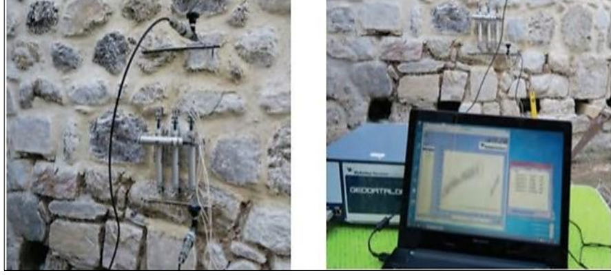
Şekil 3.72 Taş duvarda Flat-Jack deneyi (Kuran ve Dabanlı, 2016).
