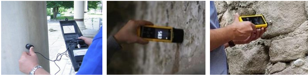
řekil 3.59 Yzey sıcaklıęını ve nemi lebilen alet (Yzer ve Ekři Akbulut) ve el tipi yzey nem ler cihazı (Pala ve Ko, 2022), (Hatır, 2019)
