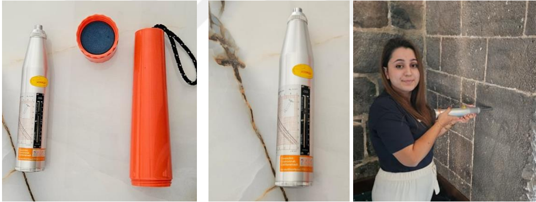
Şekil 4.54 L tipi Schmidt çekici ve yapılan ölçüm (2024)
