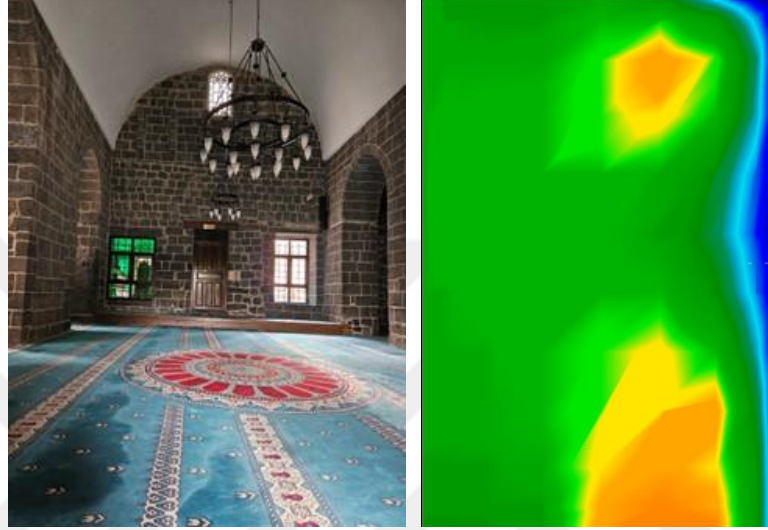
Şekil 4.101 Hz. Süleyman (Kale) Cami harim bölümünün batı yönündeki duvarı (2024) ile Georadar (GPR) tarama görüntüsü
