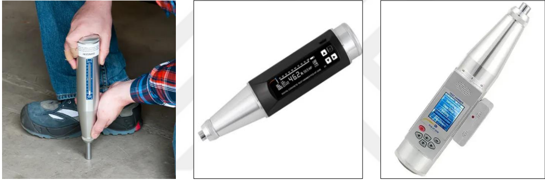
Şekil 3.56 Klasik ve dijital Schmidt çekici (PCE Instruments, 2024)
