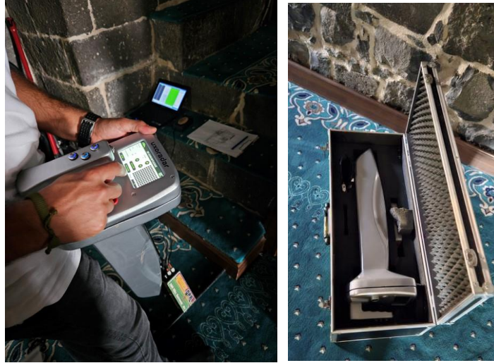
Şekil 4.60 Duvarda, ayakta ve sütunlarda kullanılan Georadar (GPR) cihazı ve yapılan ölçüm (2024)
