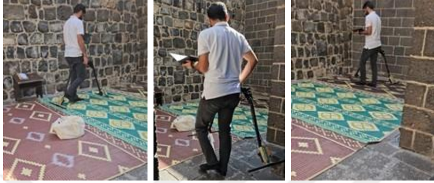
Şekil 4.89 Hz. Süleyman (Kale) Cami'de iç avluda yapılan Georadar (GPR) taraması (2024)
