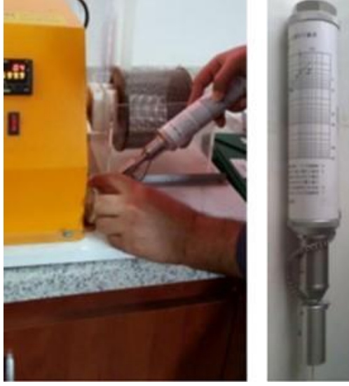
Şekil 3.75 İğne penetrometresi deneyinin uygulanışı ve mekanizması (Özdemir, 2019)
