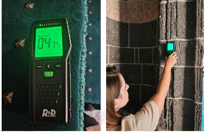
Şekil 4.58 Nem ölçüm cihazı ve yapılan ölçüm (2024)
