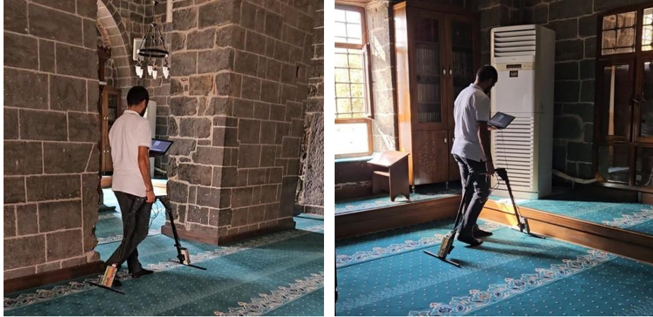
Şekil 4.94 Hz. Süleyman (Kale) Cami'de iç avluda yapılan Georadar (GPR) taraması (2024)
