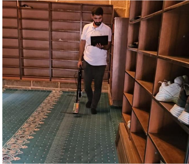
Şekil 4.86 Hız. Süleyman (Kale) Cami'de son cemaat yerinde yapılan Georadar (GPR) taraması (2024) Zemin taramaları ile 7 adet radargram elde edilmiştir. Caminin son cemaat yerinden elde edilen radargramlar karşılaştırıldığında 2 adet radargramda zemin altındaki toprağın daha ıslak olduğu ve su içerdiği tespit edilmiştir. Yaklaşık olarak zeminin 2.5
