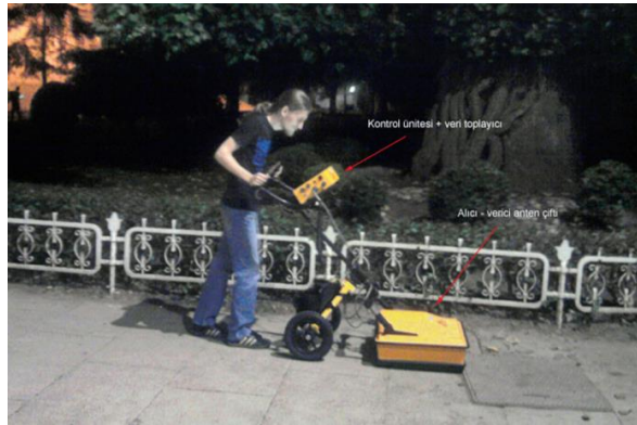
Şekil 3.69 Georadar (GPR) zemin taraması ve ekipmanları (Evren vd., 2012)
