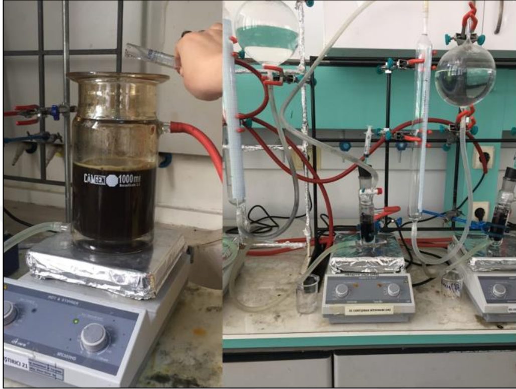
Görsel 2.2: Grafen Oksit (GO) Sentezi İçin Kurulan Düzenek.
