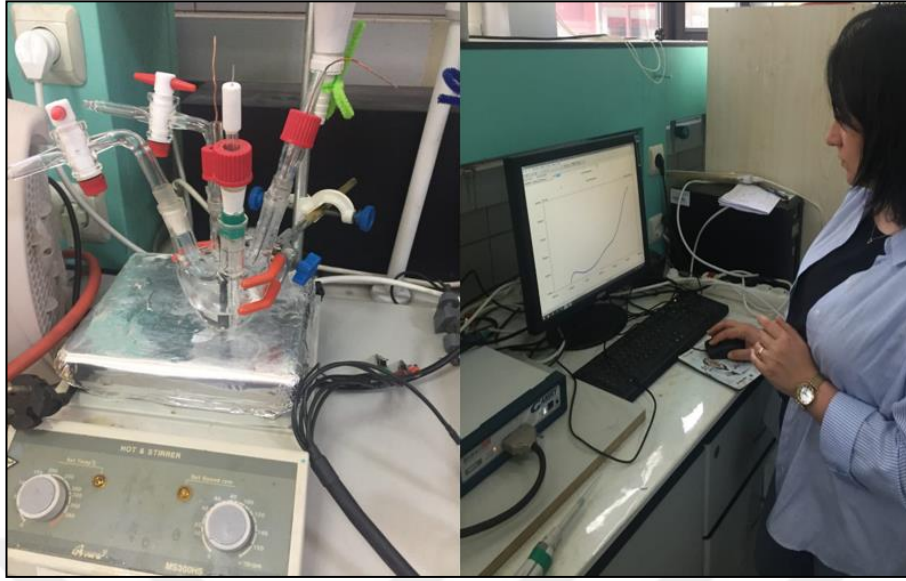
Görsel 2.1: Bir Elektrokimyasal Hücre ve Bilgisayar Kontrollü Voltametri Ölçümleri.
