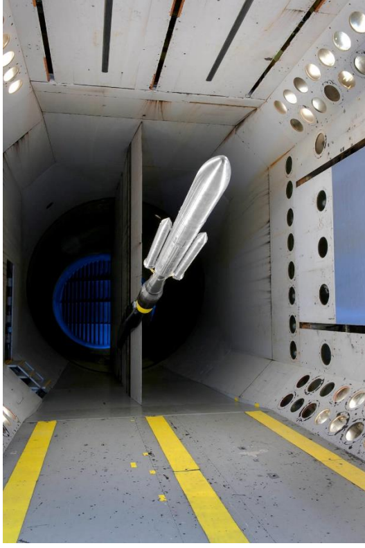
Resim 2.10. Roket transonik rüzgar tüneli testi [23]
