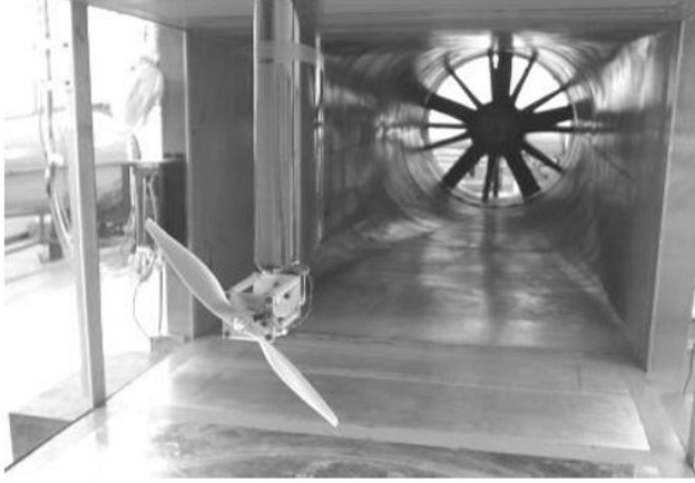
Resim 3.2. Pervane testleri için kullanılan rüzgar tüneli [43]
