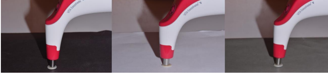
Resim 3. 10. Siyah, beyaz ve gri arka planda örneklerin renk ve translüensi ölçümlerinin yapılması
