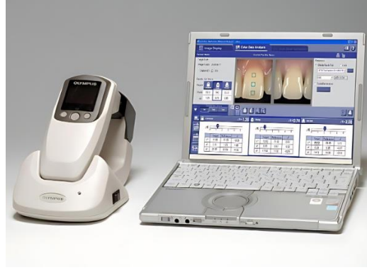
Resim 2. 17. Crystal Eye (Olympus, Tokyo, Japan) spektrofotometresi (Odaira ve ark., 2011)
