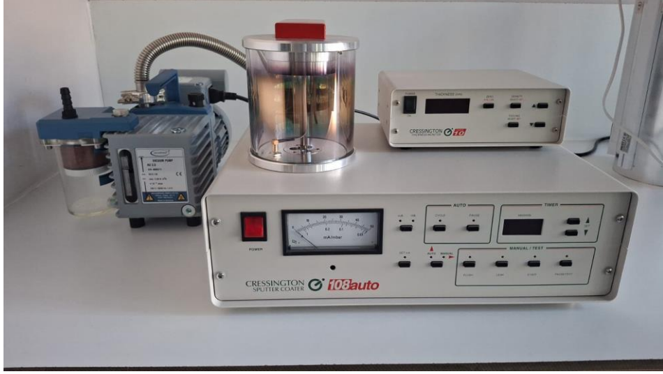
Resim 3. 11. Çalışmada kullanılan altın kaplama makinesi
