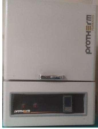
Resim 3. 3. Çalışmada kullanılan sinterizasyon fırını
