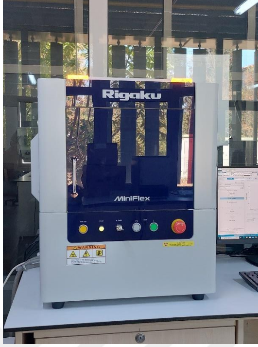
Resim 3. 13. Çalışmada kullanılan XRD cihazı
