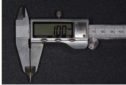
Resim 3. 4. Örneklerin 1 mm kalınlıklarının elektronik kumpasla ölçülmesi
