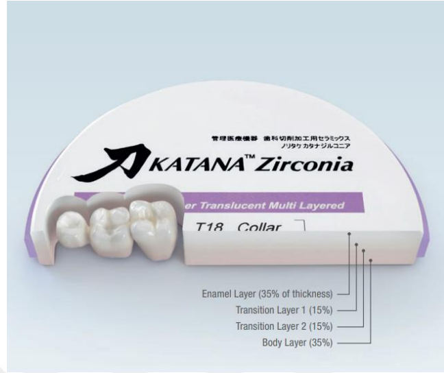
Resim 2. 2. Katana STML bloğun katmanları ("STML blok,")
