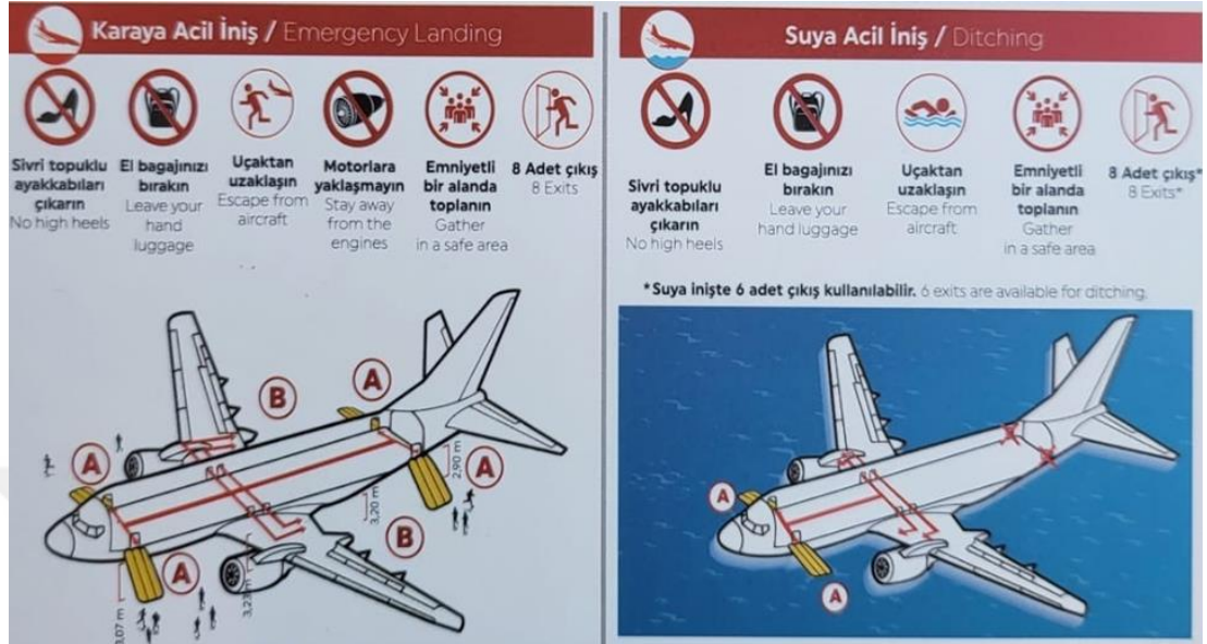
Resim 3.12. Uçuş güvenlik kartında uçağın genel yapısının, acil çıkış ünitelerinin ve komutlarının gösterimi ve kara/su acil iniş ayrımının belirtilmesi
