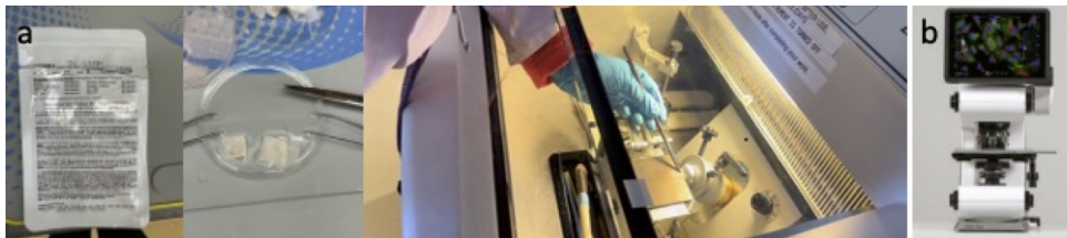
Şekil 3.4 Floresan mikroskop görüntüleme çalışmaları için numune hazırlığı(a); ECHO Revolve Mikroskop (b)
