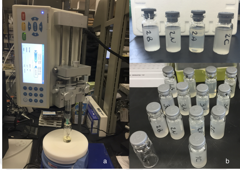
Şekil 3.2 Modifiye Edilmiş Etanol Enjeksiyon Yönteminin Deney Düzenegi (a); Modifiye Edilmiş Etanol Enjeksiyon Yöntemi ile Hazırlanan Örnekler (b)
