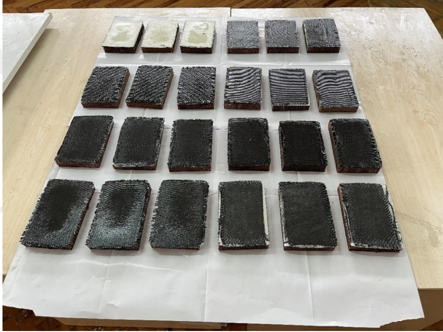
Şekil 3.8. Kürleme fırınına girecek şekilde hazırlanmış panel kaplama numuneler
