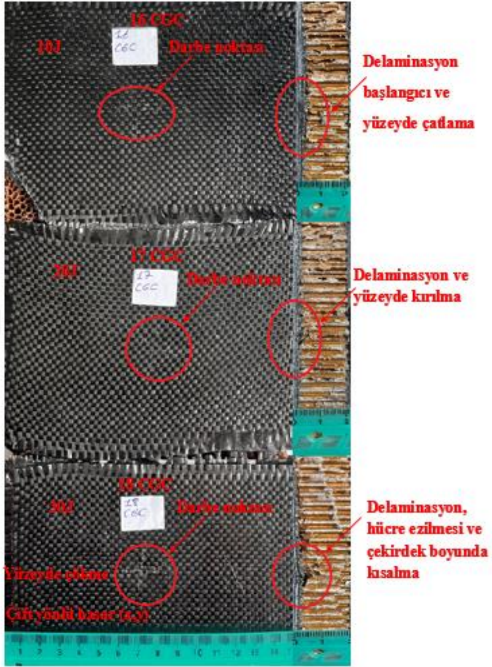
Şekil 4.30. 10J-20J-30J enerji seviyelerinde 16.17.18. numunelerin hasar analiz görüntüsü
