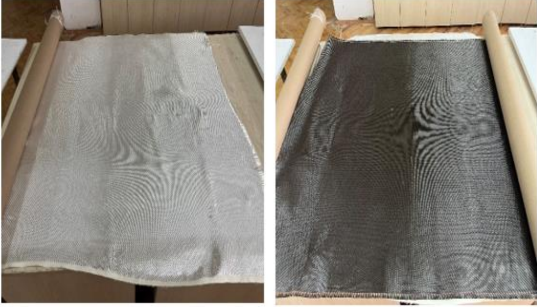
Şekil 3.5. Kesim için hazırlanan cam ve karbon elyaf kumaşlar
