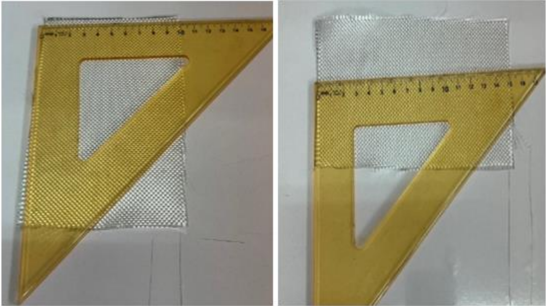
Şekil 3.6. Numune panellerin kaplamasında kullanılmak üzere kesilen 100 mm x 150 mm ebatlarındaki elyafların ölçü kontrolü
