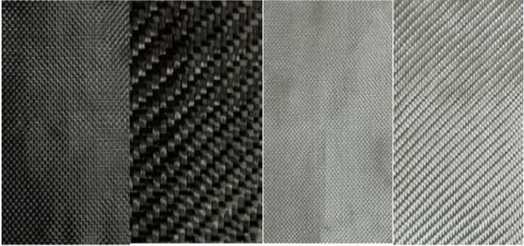
Şekil 3.1. Plain karbon elyaf dokuma, twill karbon elyaf dokuma, plain cam elyaf dokuma ve twill cam elyaf dokuma
