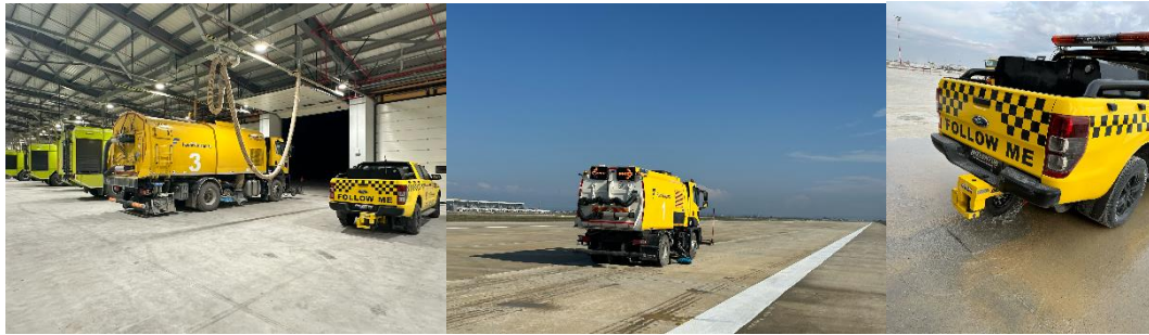
Görsel 6.4. Hareket alanında bulunan FOD, pist frenleme ölçüm aracı, follow me uçak hizmet araçları (Yazar tarafından oluşturulmuştur)
