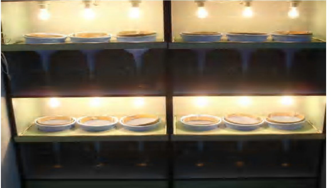
Şekil 2.4. Berlese hunilerinden oluşan toprak akarlarını ayıklama düzeneği.
