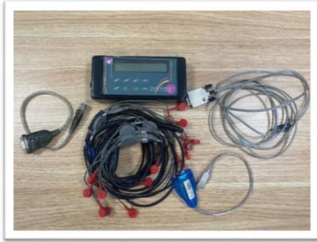
Şekil 3.18. Yüzeysel EMG ölçümleri ME3000P8 marka cihazı (Mega Electronics, Finland) yapılmıştır.
