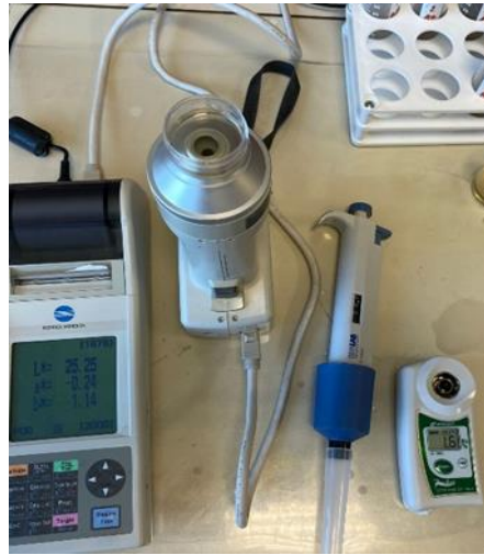
Şekil 3.8. Çalışmada kullanılan kolorimetre (sol) ve dijital refraktometreye (sağ) ait görsel
