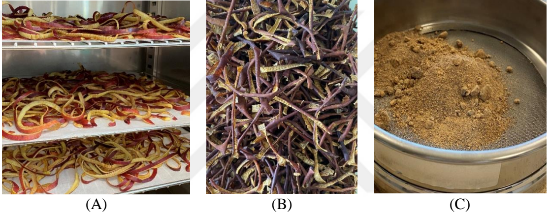
Şekil 3.2. Elma kabuklarının etüvde kurutulma işlemi (A), kurutulmuş elma kabuklarının görüntüsü (B) ve öğütülen kabukların elekten geçirilmesine (C) ait görsel
