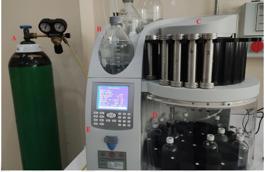
Şekil 3.6. Hızlandırılmış solvent ekstraksiyon sistemine (Dionex ASE 350 marka) ait görsel (A: Azot gazı, B: Solvent, C: Ekstraksiyon hücreleri, D: Ekstrakt toplama kapları, E: Kontrol paneli)
