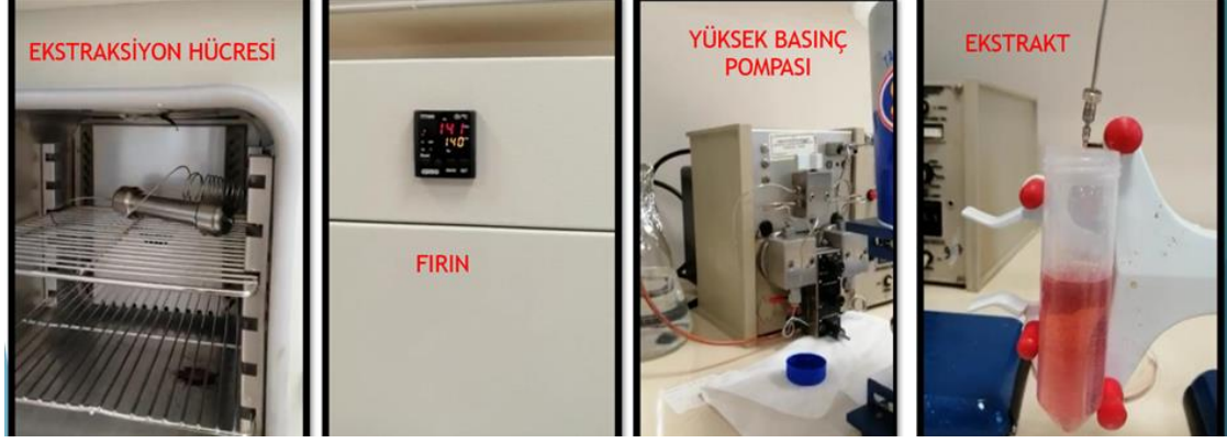
Şekil 3.5. Laboratuvar ölçekli kritik altı su ekstraksiyonu sisteminin detaylı görüntüsü
