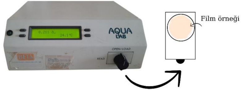
Şekil 14. Su aktivitesi ölçüm cihazının okuma gözü
