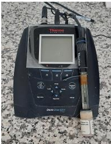
Şekil 2.3: pH metre (Skymen Orion Star A211 Star)
