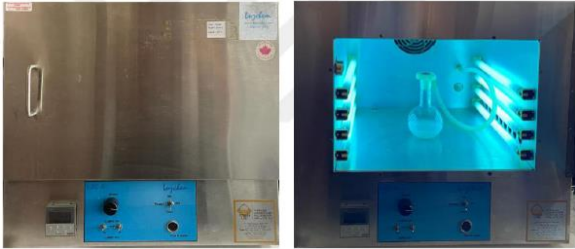
Şekil 3.1: Luzchem LZC-5 model fotoreaktör sistemi.]
