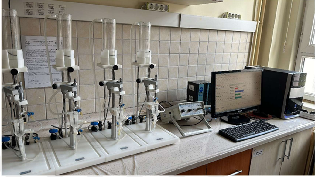
Şekil 2.1. İzole organ banyosu sistemi (MAY IOBS 99, Commat, Türkiye), OMÜ Veteriner Fakültesi, Veterinerlik Farmakoloji ve Toksikolojisi Ana Bilim Dalı Laboratuvarı, 2023
