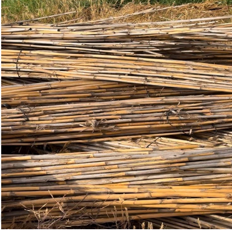
Fotoğraf 11: Kargı, üstleri bıçakla soyulduktan sonra yargıçla üçe ayrılarak kullanılıyor 53 .
