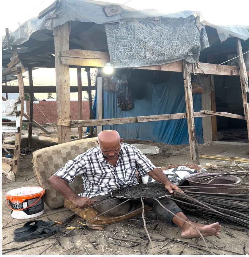
Fotoğraf 15: Sepetin tabanına dikeçler yerleştirilirken.
