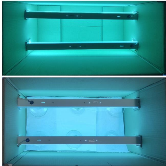
Şekil 4.3. Saf ve farklı tür kumaşlarda fotokatalitik etkinin incelenmesi için kurulan düzenek
