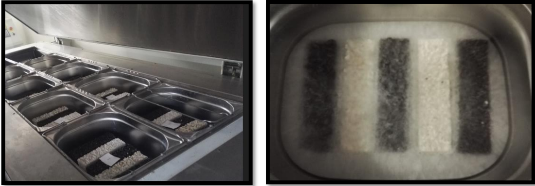
Şekil 3.5. D-Ç deney aleti ve deney numuneleri
