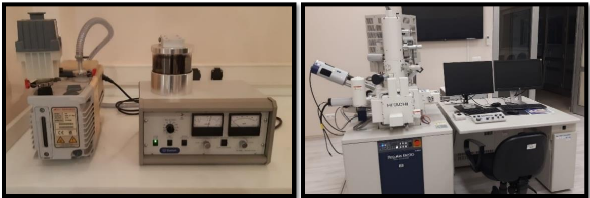
Şekil 3.6. Numunelerin kaplanması (a) ve Mikroyapı analizinde kullanılan SEM cihazı (b)
