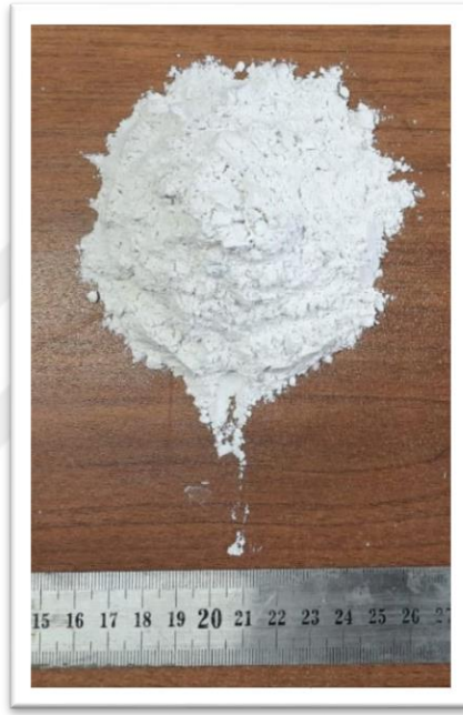
Şekil 10. Kalsit ocağı filtre atık görüntüsü.
